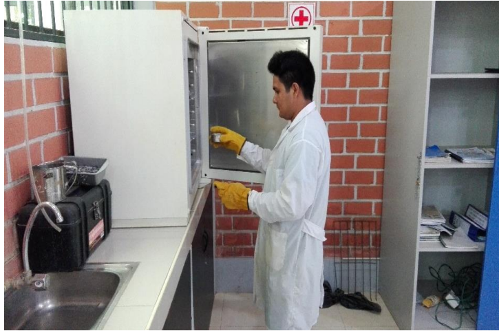
Figura 33. Colocando en el horno el material
