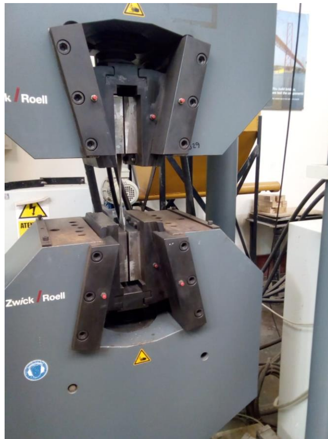
Figura 29: Sujecion de probeta mediante mordazas
