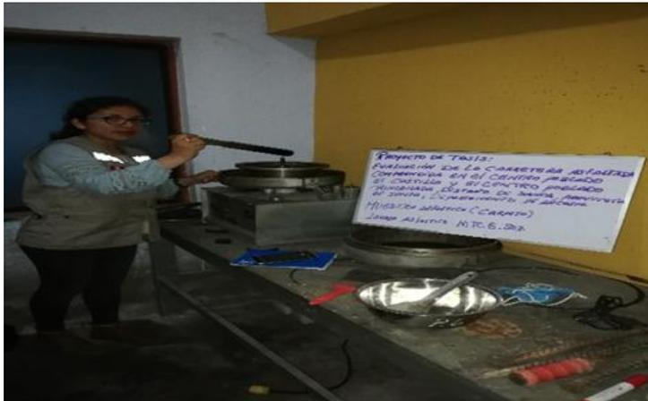
**Foto 52:** Se verifica la desintegración de la mezcla asfáltica – cemento asfáltico.
