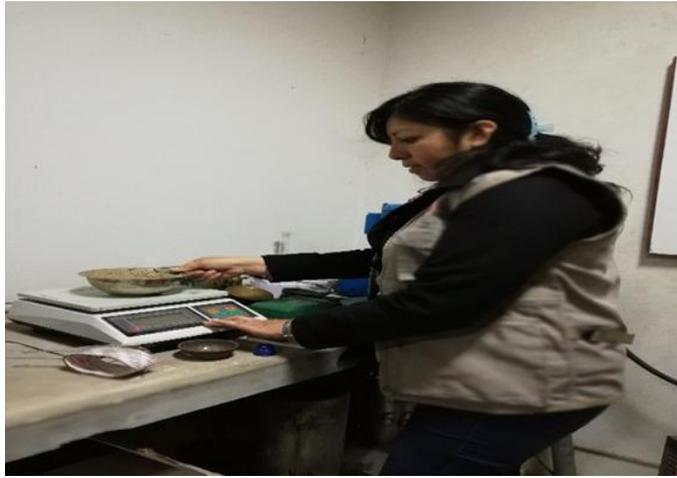
**Foto 34:** Se realiza el ensayo de contenido de humedad de lo cual se extraes una muestra en una tara y luego se pesa en una balanza para tomar dato.
