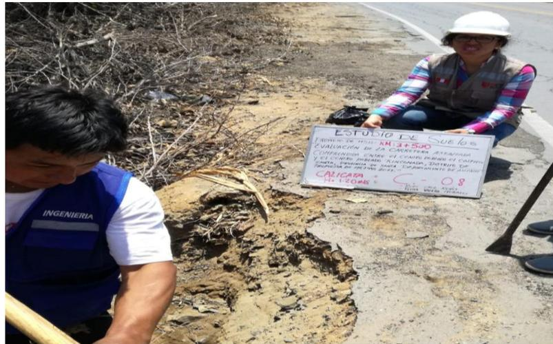
**Fotos 30:** Se procede a excavar la calicata en la progresiva 4+000
