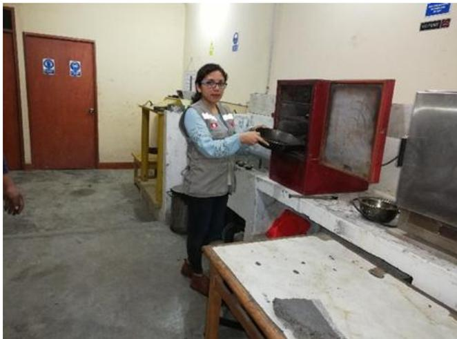
**Foto 55:** Luego se lleva al horno para el secado del agregado de la muestra asfáltica..
