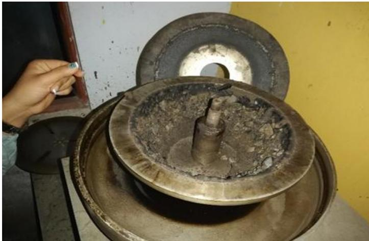
**Foto 53:** Se verifica la desintegración en agregado de la muestra asfáltica.
