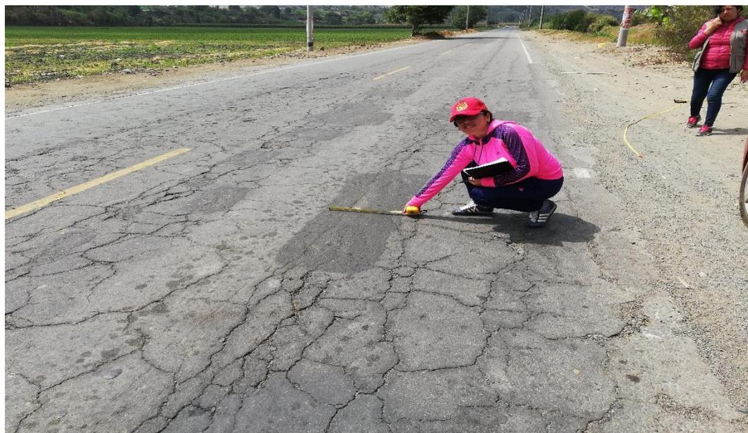
**Foto 07:** Se realizó la medición de las fallas de Parches.
