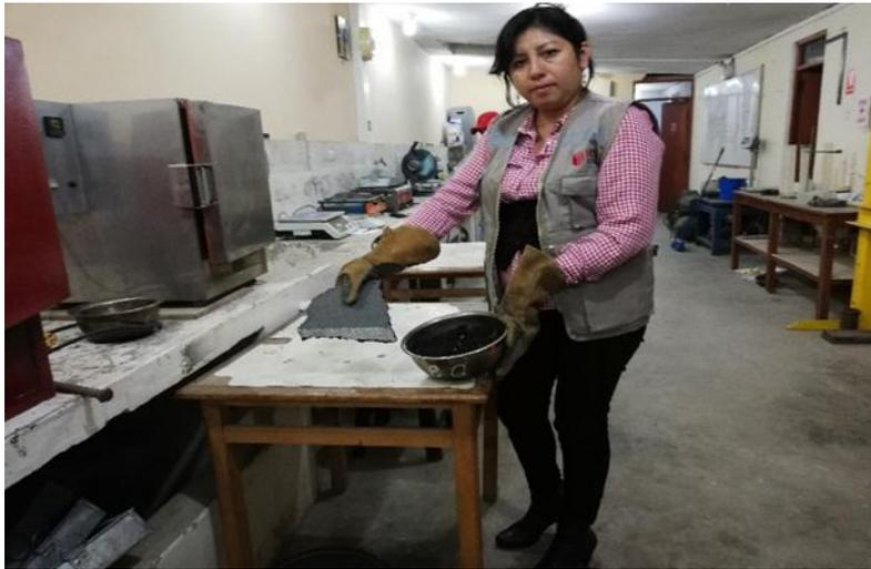
**Foto 48:** Muestra del asfalto en el laboratorio – desintegración de la muestra asfáltica.
