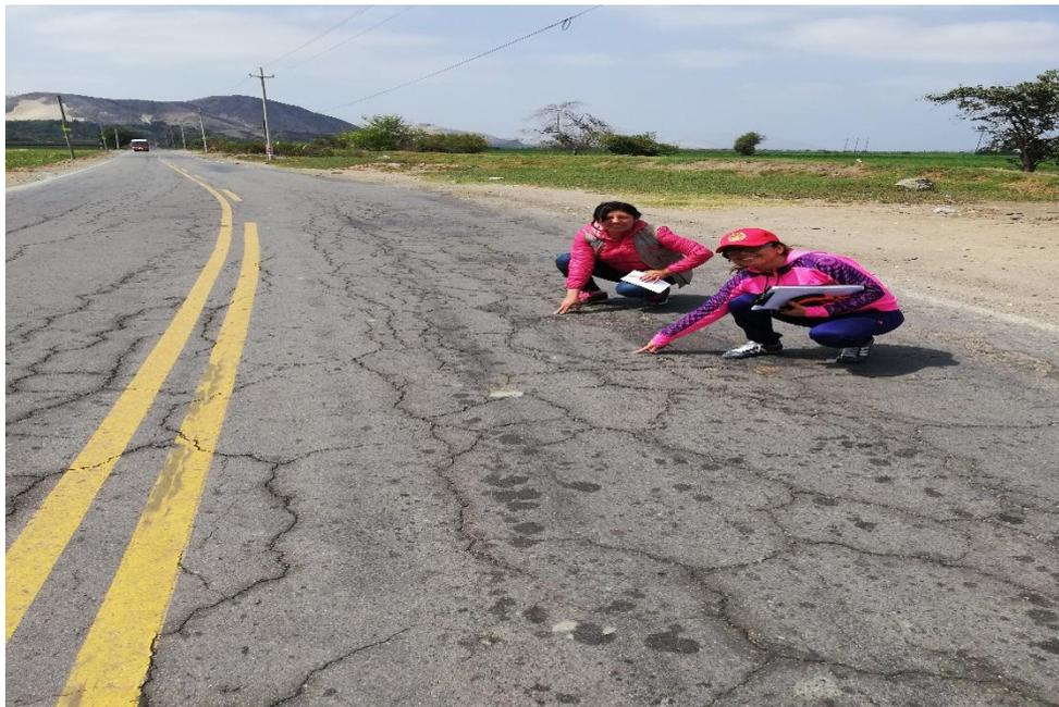
**Foto 04:** Se realizó las medición de las fallas fisuras de bloque.
