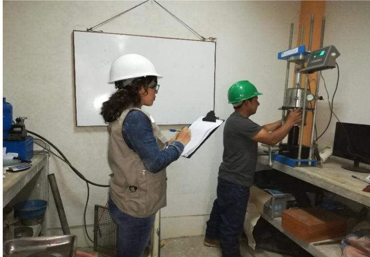
**Foto 46:** Luego de saturar la muestra por 96 horas, se pasa a la prensa para la penetración vs carga de lo cual se tomara dato.
