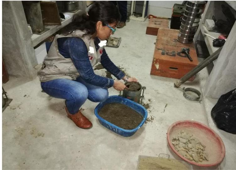
**Foto 42:** Luego se separó por cada molde una muestra de 6 kg y realizamos un porcentaje de agua.
