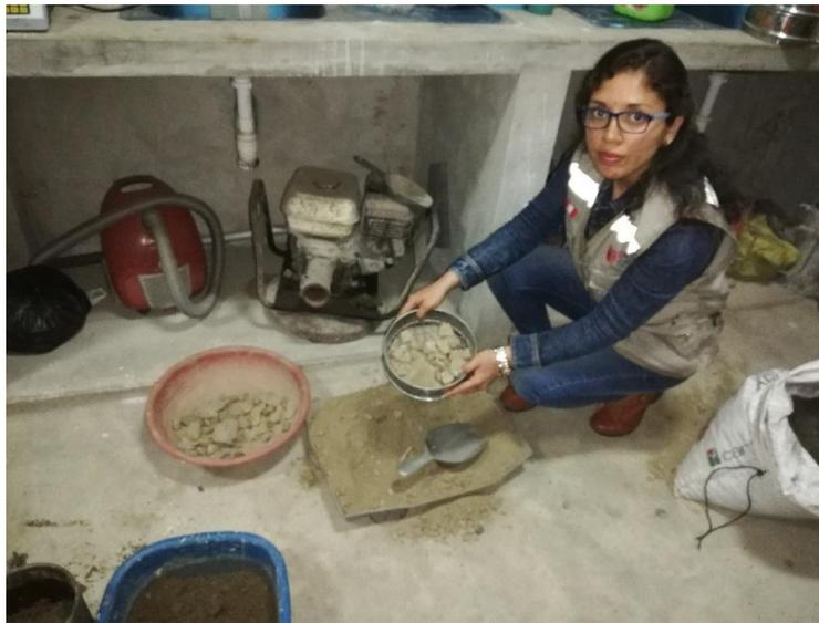
**Foto 41:** Se procedió a realizar el CBR de lo cual se trajo una muestra de afirmado de 30 kg lo cual tamizamos con la malla #3/4.
