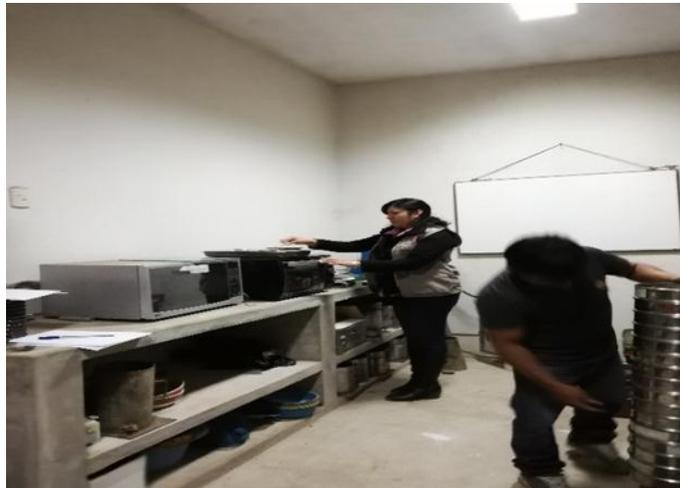
**Foto 35:** Luego que se pesa el contenido de humedad se pasa al horno para secar la muestra 24 horas, lo cual tendrá una temperatura de  $110 \pm 10$  °C.
