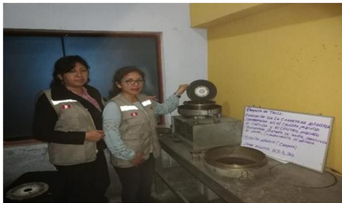
**Foto 51:** Se procedió a colocar el filtro a la centrifugadora.
