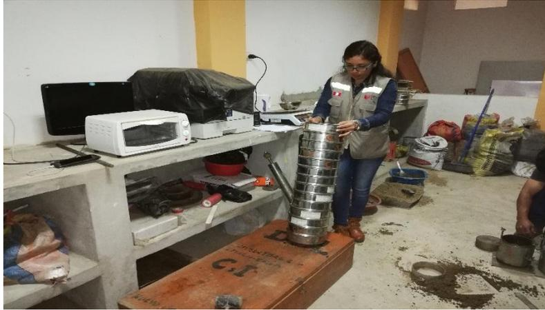
**Foto 36:** Se pasa hacer el análisis granulométricos de cada muestra extraídas de las calicatas en este caso como fue terreno natural se utilizó las mallas #4, #10, #16, #30, #40, #50, #100, #200, <200
