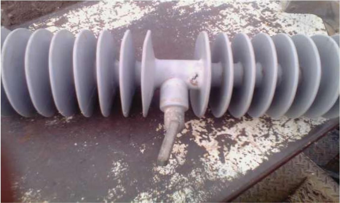
**CUT-OUT POLIMERICO DETERIORADO**
