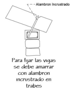
Figura 77: Fijación de Listones a Viga.
