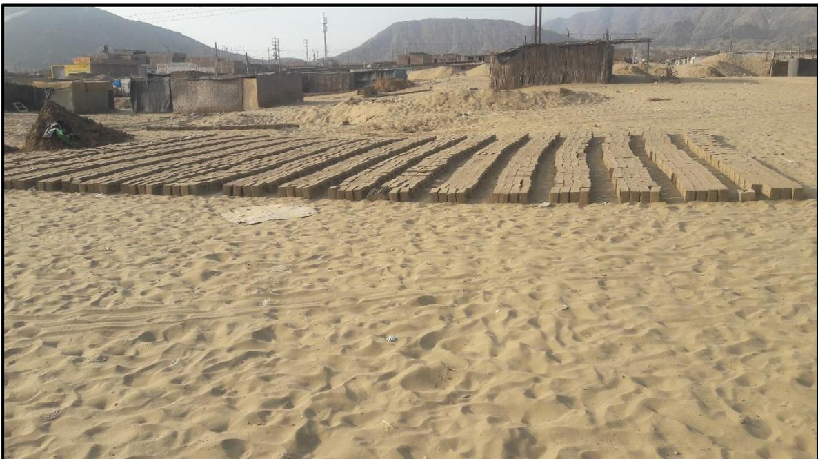
**Figura 232:** Estas viviendas con construidas de ladrillo no cocido al ser un material fácil de elaborar y accesible en la zona.
