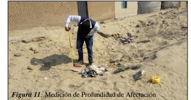
Figura 11: Medición de Profundidad de Afectación
