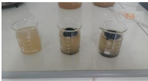
Imagen N°04: aplicación del carbón activado.
