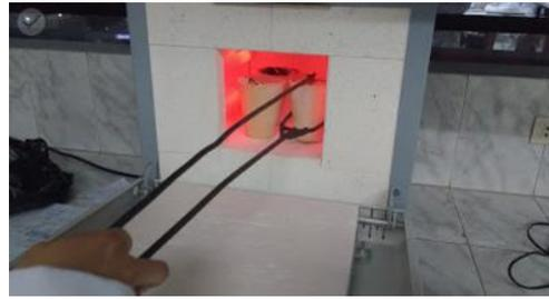
Imagen N°02: introducción de materia prima a mufla para la fabricación del
