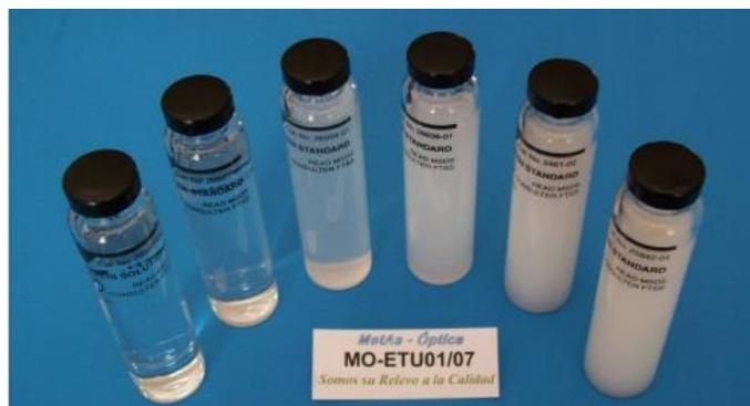
Figura 5: MRC de turbidez, materiales sellados de formazina (tomado de <http://www.metass.com.mx/guiametas/la-guia-metas-10-01-turbidez.pdf>, 2016).
