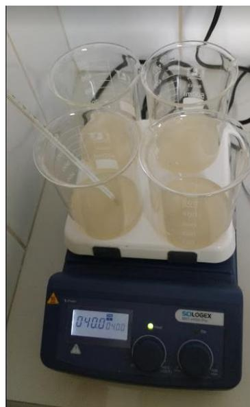
Imagen N°11: verificación de la temperatura de las muestras.
