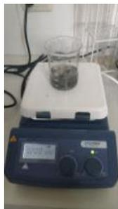
Imagen N°07: agitación de muestras en agitador
