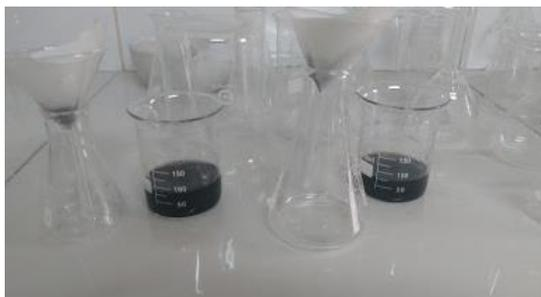
Imagen N°08: filtración de muestras de agua con la aplicación de carbón
