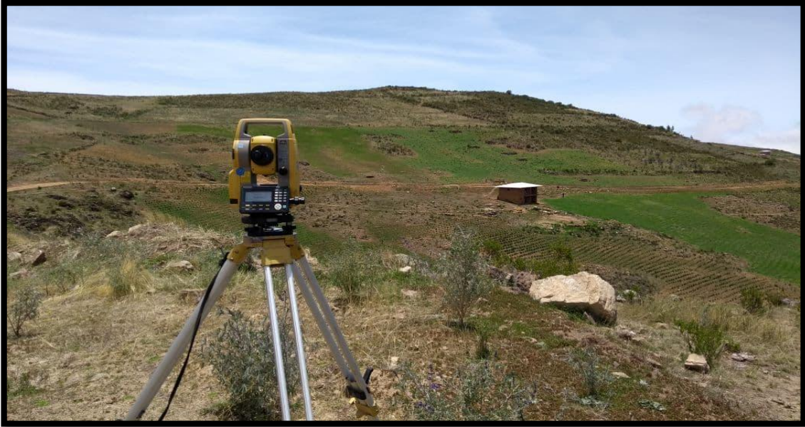
Estación Total Topcon Es-105, para obtener los puntos topográficos.
