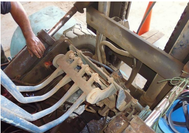
Ilustración 22. Verificación de la caja de cambios del montacarga cada 500 a 1000 horas
