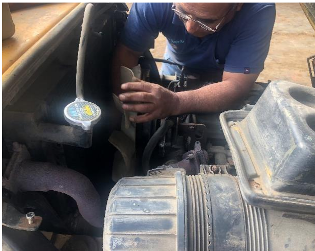
Ilustración 18. Revisión de estado de mangueras hidráulicas cada 500 horas
