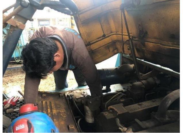
Ilustración 17. Limpieza del radiador cada 300 horas
