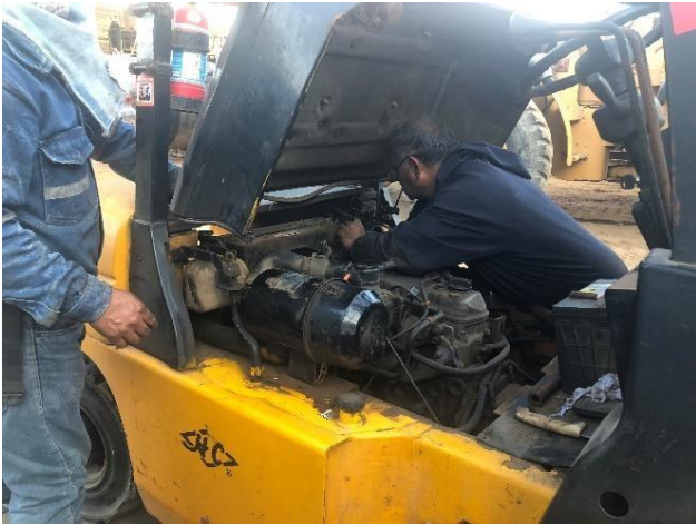
Ilustración 16. Revisar el encendido y sincronización del cigüeñal cada 100 horas
