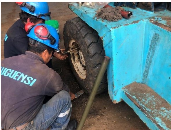
Ilustración 12. Revisar/lubricar los rodamientos de rueda del eje de dirección cada 100 horas
