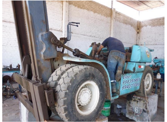
Ilustración 21. Limpieza de guías de mástil de elevación cada 500 horas
