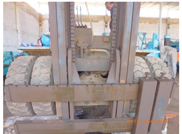
Ilustración 23. Revisar el ajuste y nivel de desgaste de las cadenas elevadoras cada 1000 horas
