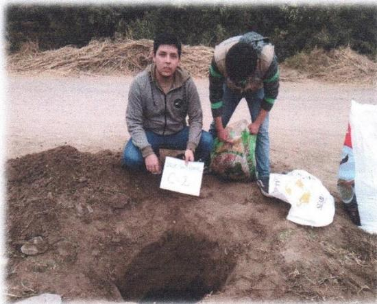
En la imagen se aprecia la toma de muestra aproximadamente 30 kg para realizar los ensayos correspondientes.
