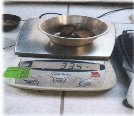
En la imagen se aprecia el pesado de las taras y el pesado de la tara más la muestra para la obtención del contenido de humedad
