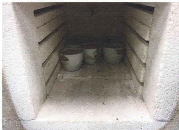
En la imagen observamos la colocación de la cascara de arroz precalcinado al horno en un crisol de porcelana el cual soportara altas temperaturas como 450°C el cual es lo requerido para su calcinación en el horno mufla en el laboratorio de química en la Universidad Cesar Vallejo.
