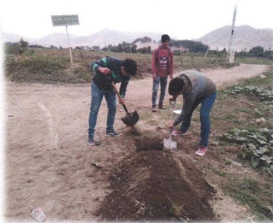
En la imagen se observa la excavación de calicata para la obtención de muestras para ser analizadas en el laboratorio
