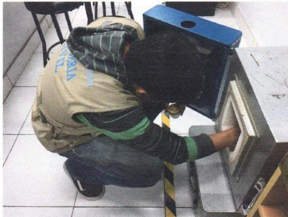
Ya en el laboratorio se coloca la cascara de arroz en pasillos pequeños de porcelana que soportan altas temperaturas, luego se lleva al horno para su pre calcinación a una temperatura de 120°C por un lapso de 3 horas, para posterior a ello realizar la calcinación.
