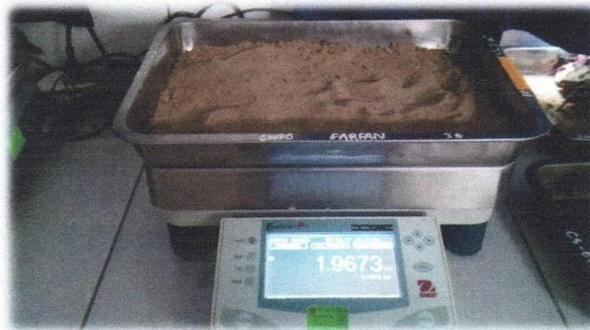
En la imagen se aprecia el pesado de la muestra para empezar con la realización del tamizado
