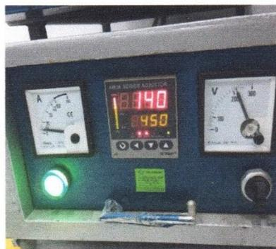
El horno Mufla de 6L que se aprecia en la imagen es de propiedad de la Universidad Cesar Vallejo el cual llega hasta temperaturas de 1200°C para poder realizar ensayos, ya colocados las muestras, se regula la temperatura a ensayar.
