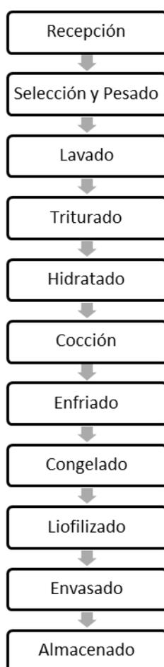
**Figura 1.** Diagrama de flujo para la obtención de harina de Cushuro (*Nostoc Commune Vauch*)
