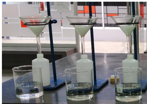
Figura 23 Embudo, soporte universal, botellas de polietileno, papel filtro y vasos de precipitados
