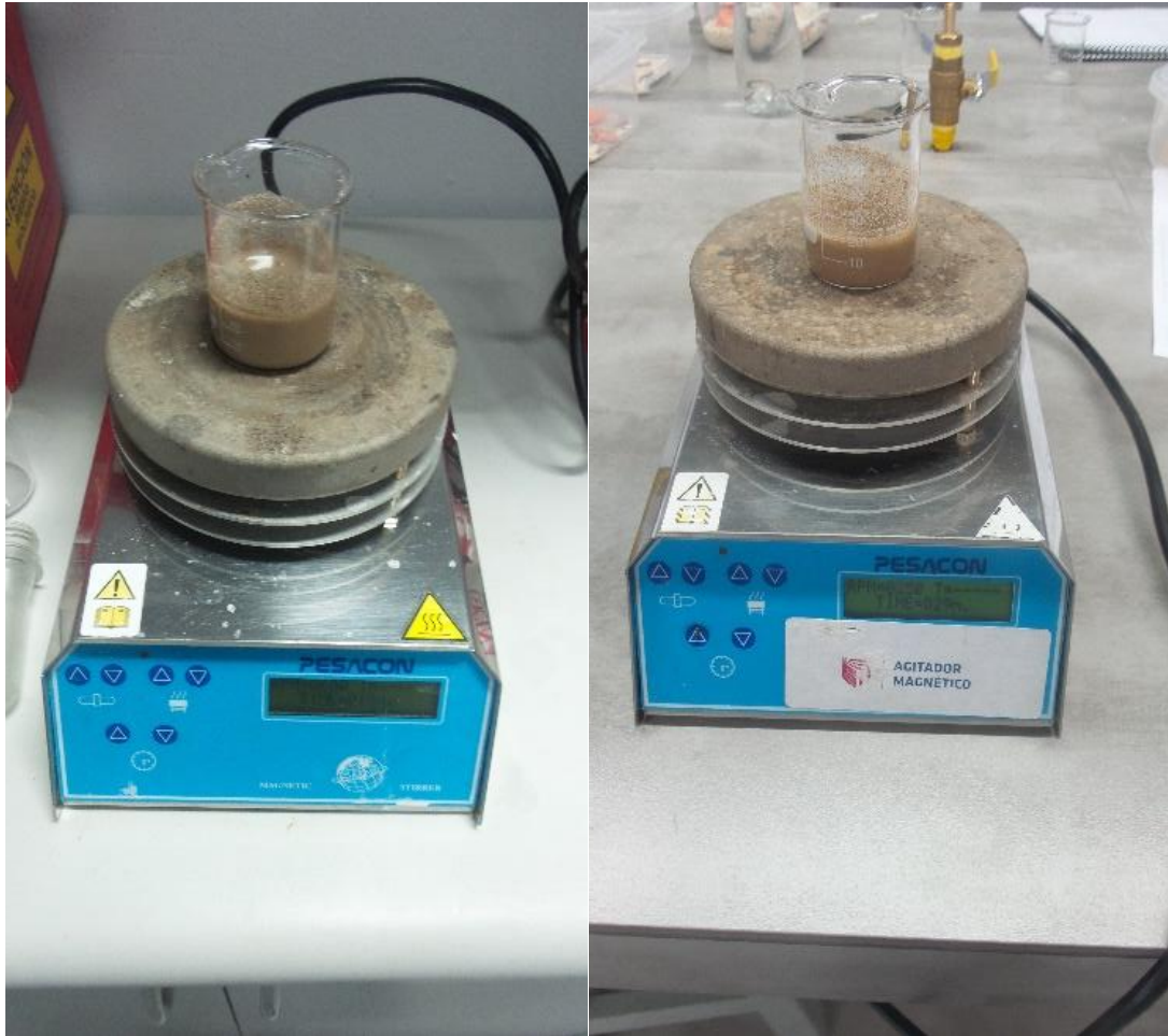
Fotos 15 y 16: Uso de agitador magnético para la medición de conductividad eléctrica de los productos obtenidos.
