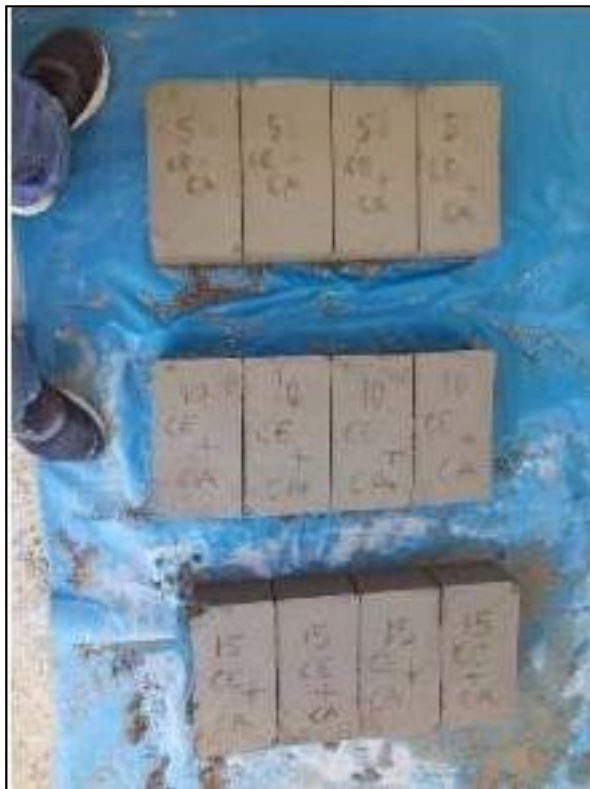
Fotografía 06: Bloques de concreto con adiciones de 5%, 10% y 15% de ceniza y de cachaza.
