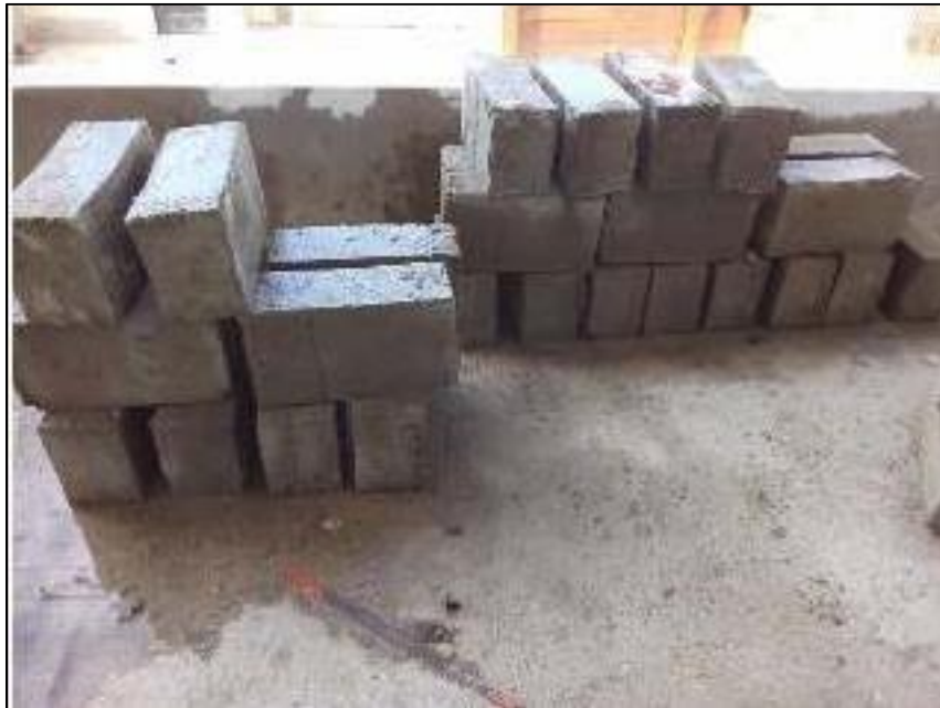
Fotografía 05: Desmolde de los bloques de concreto de muestras con adiciones de ceniza y cachaza.
