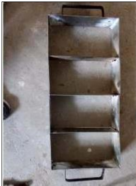
Fotografía 04: Molde para los bloques de concretos.
