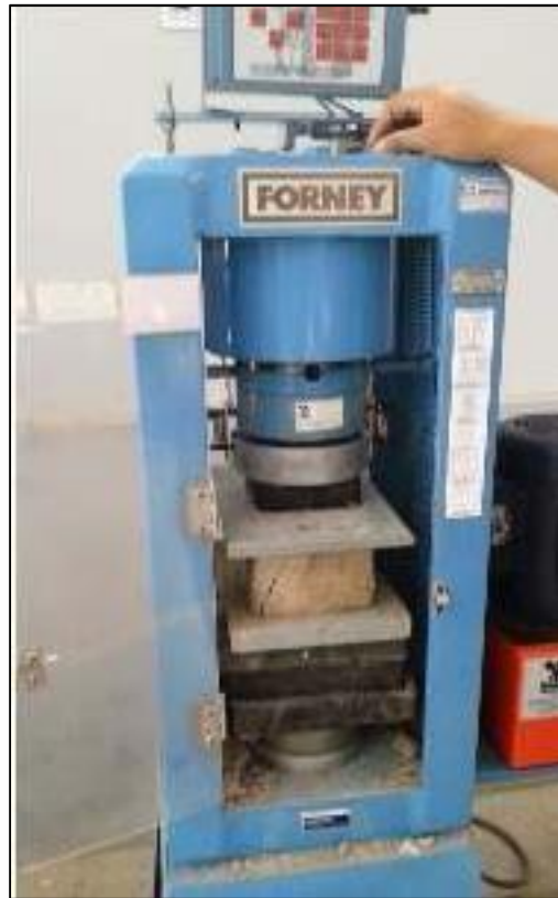
Fotografía 07: Muestra de bloques de concreto con 5% ceniza sometido a fuerza de compresión.
