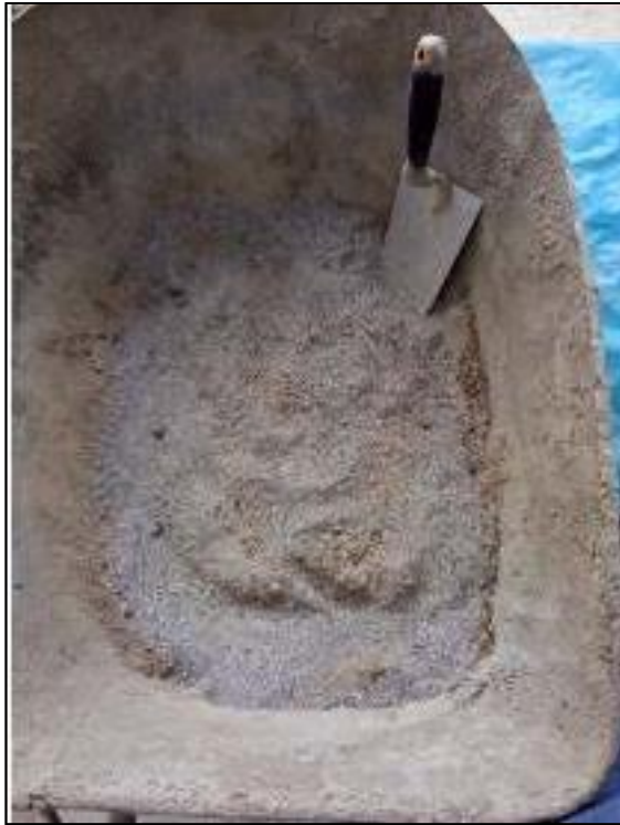
Fotografía 03: Mezcla siendo preparada, para la elaboración de los bloques de concreto con adiciones de ceniza.
