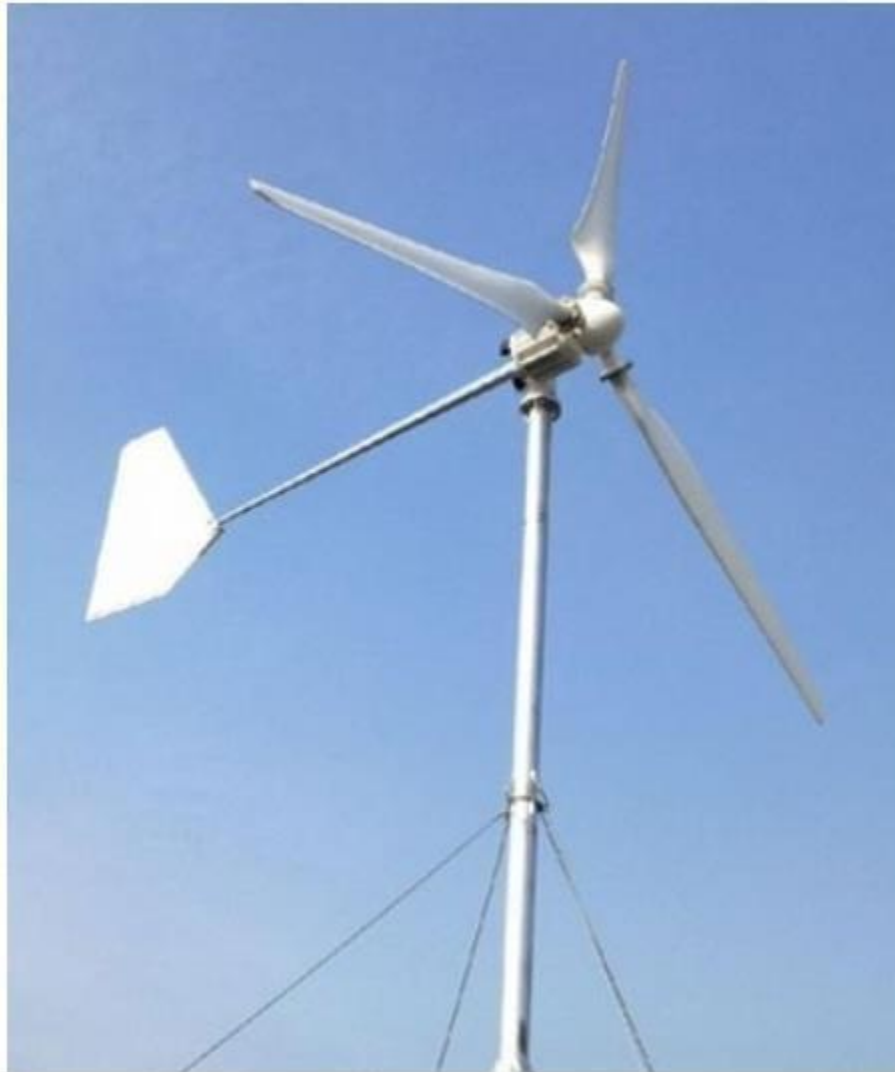
Turbina a utilizar, de 3 aspas y eje horizontal
