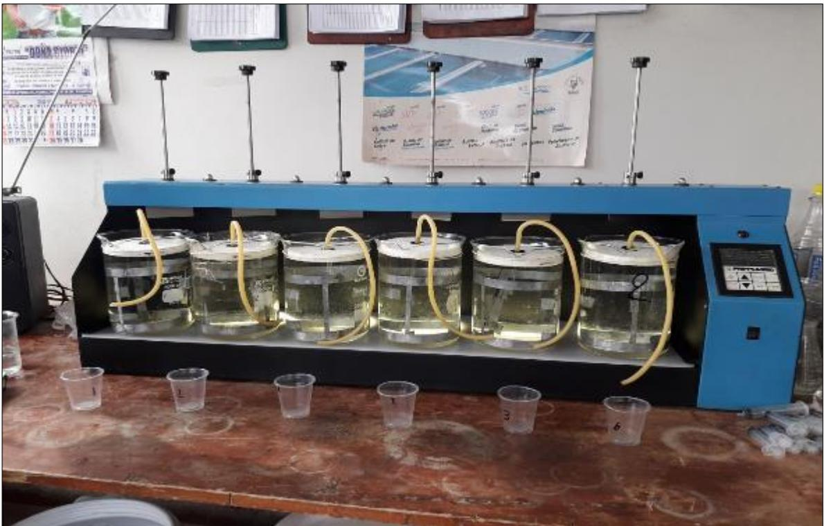
*Fig. 5 Frascos de 120 ml para la recolección de agua decantada y su medición de turbidez.*
