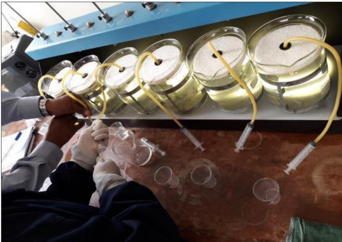
Fig. 12 Extracción del agua decantada de los sifones a través del sistema de succión y mangueras. Las jeringas hipodérmicas ayudan a la extracción sin levantar los flocs decantados.
