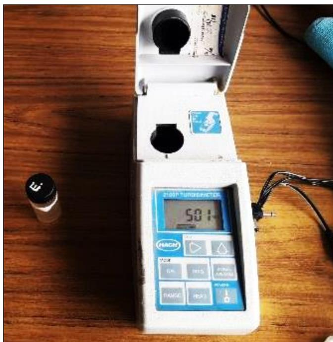
*Fig. 16 Equipo turbidimétrico.*
