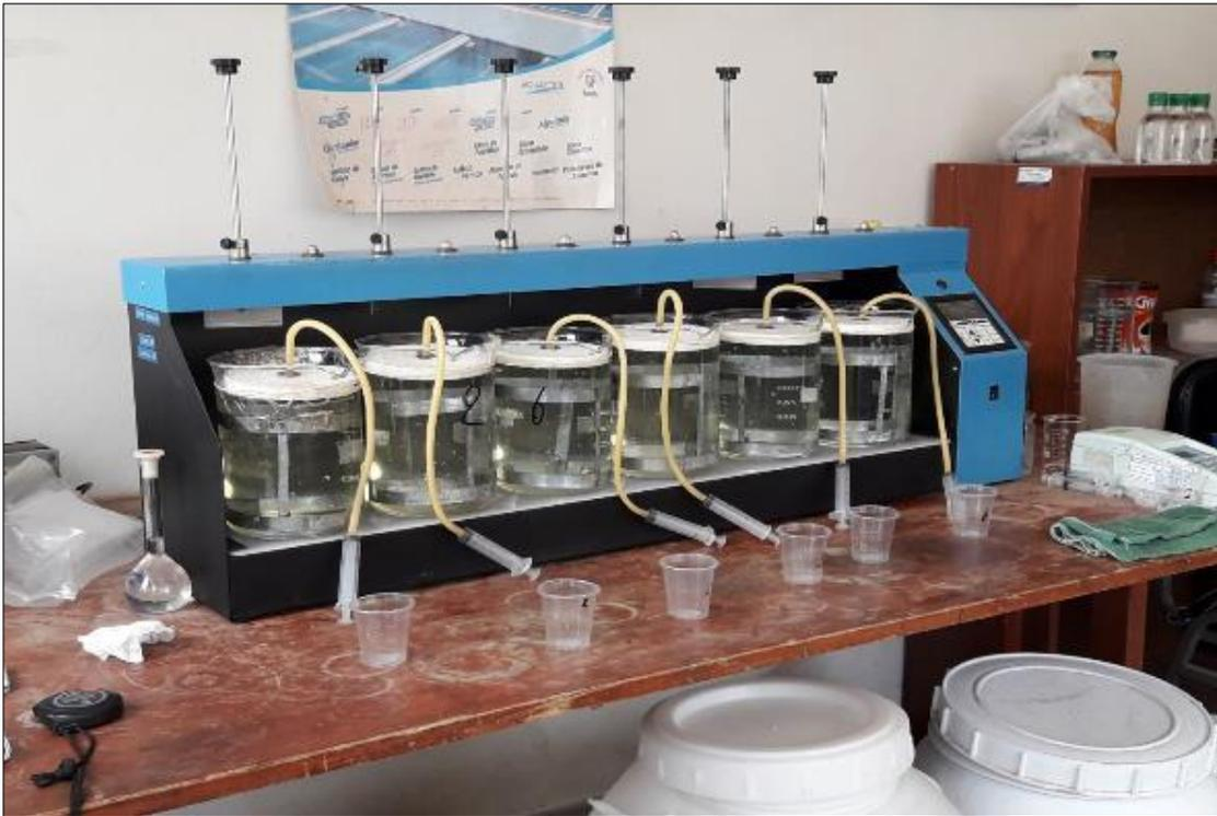
*Fig. 1 Equipo de Prueba de Jarras donde se realiza la simulación del proceso de floculación - decantación para el tratamiento del agua para consumo humano.*
