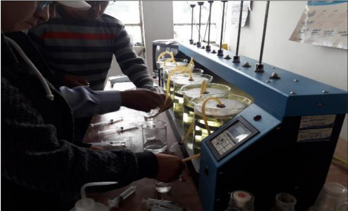
*Fig. 6 Se recolecta el agua decantada en Beakers de 250 para poder realizar las pruebas de aluminio residual y alcalinidad, necesarias para junto a la turbidez poder determinar la dosis óptima.*
