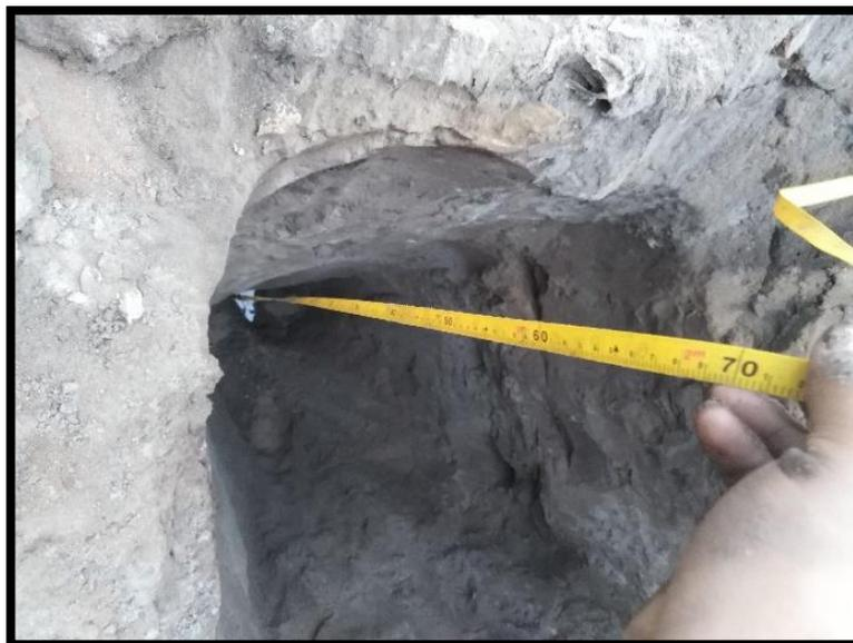
Figura 10: C- 2 Nivel de napa freática: 2.60 m
