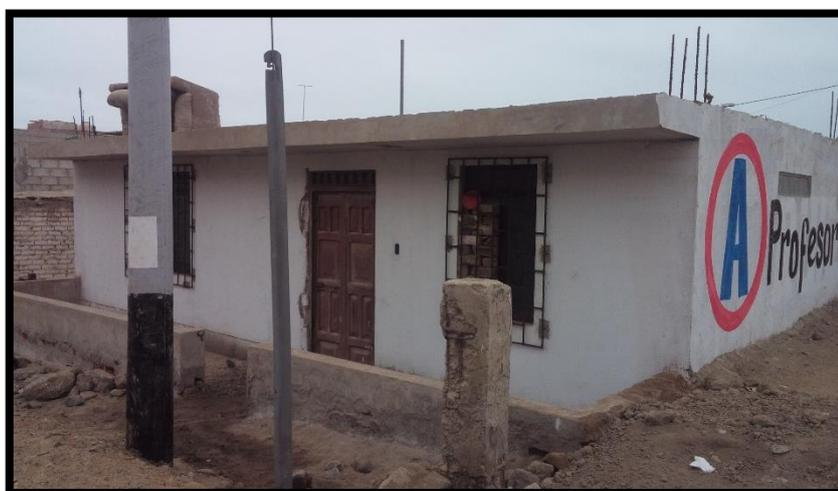
Figura 3: Vivienda de 1 nivel - columna y vigas de concreto, muro de ladrillo crudo.
