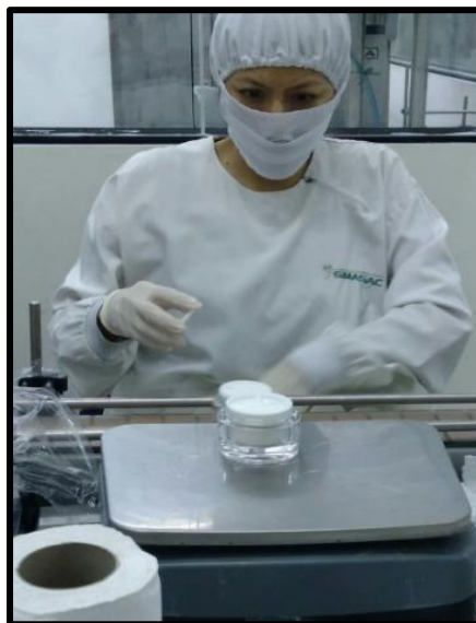
Figura 30: inspección de peso neto en línea (mejora).
