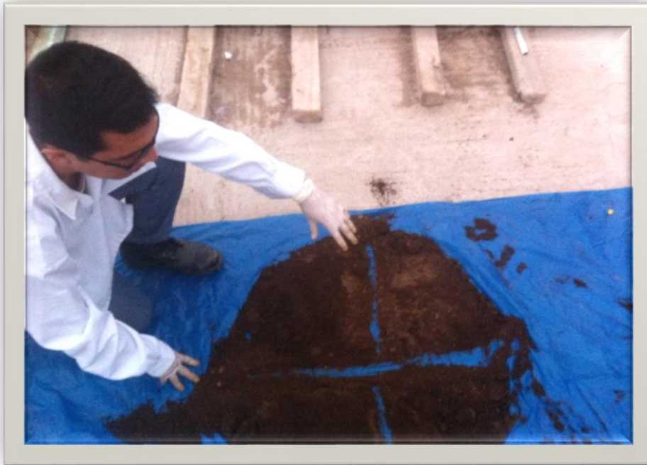
Foto N°1: Realizando el método del cuarteo para la obtención de 500 g de muestras.
