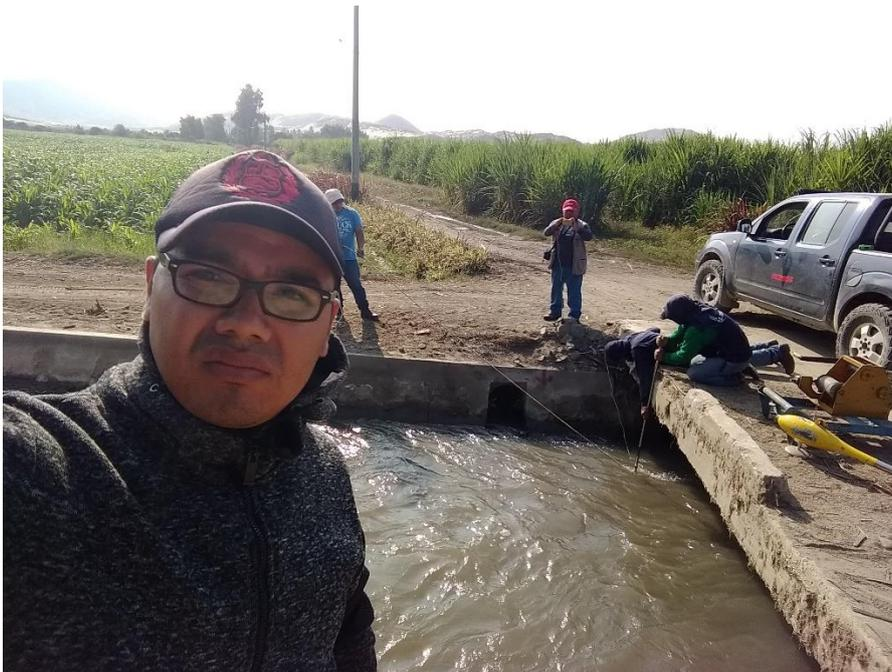
**FOTO N°05:** En la imagen se aprecia el desarrollo del primer aforo en la progresiva 1+680 para lo cual se llevó a cabo con tres ayudantes y un técnico y se utilizó como equipos de medición un correntómetro, un lastre y un guinche para la estabilidad del equipo.
