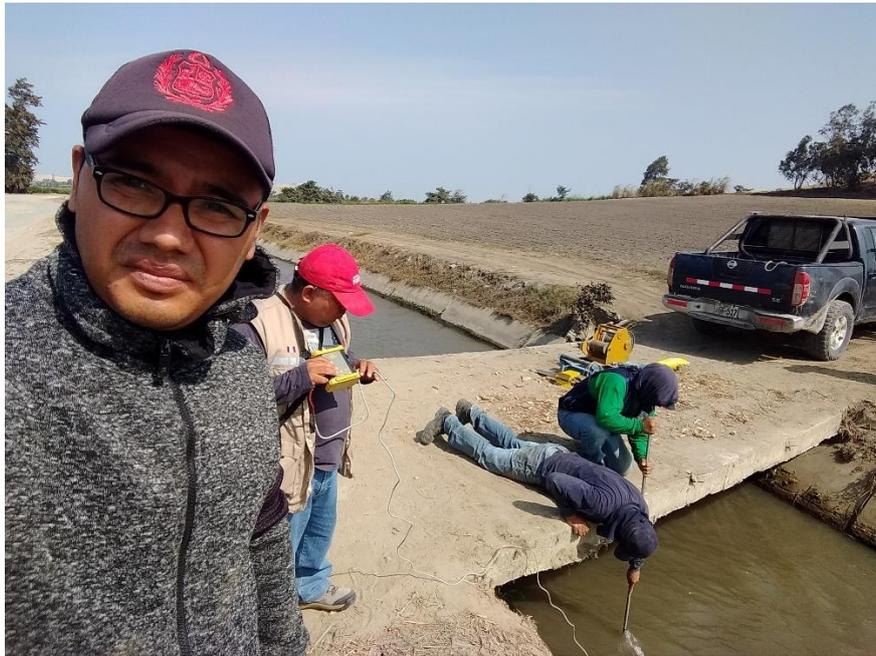
**FOTO N°06:** En la imagen se aprecia el desarrollo del segundo aforo en la progresiva 6+730 para ello se realizó las mediciones del ancho de la sección transversal del espejo de agua para determinar las áreas como también el tirante del canal para identificar los puntos de ingreso del correntómetro. La profundidad a ingresar el correntómetro es a un 60% del tirante.
