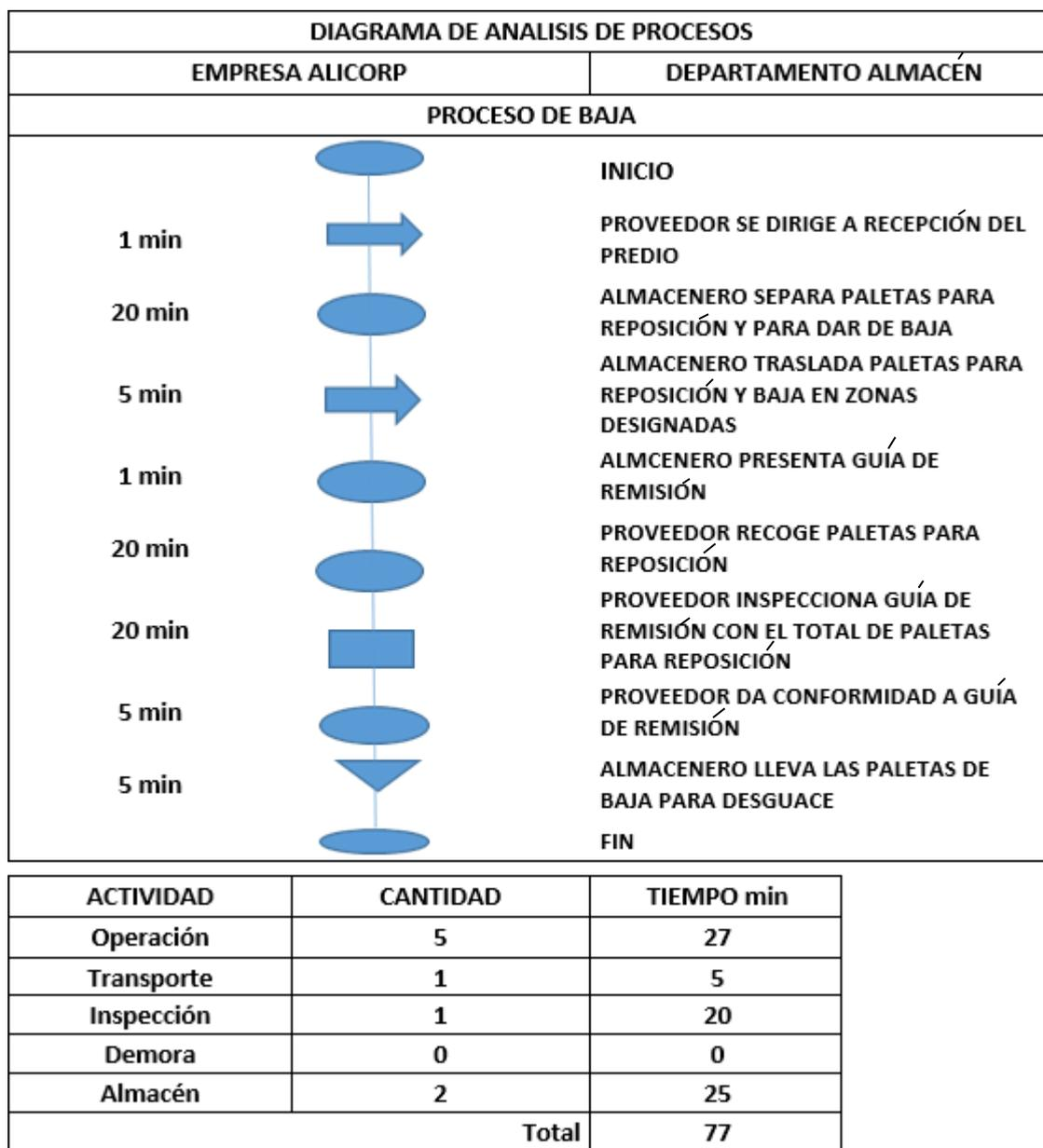
Figura Nro 28 Diagrama de Proceso de Baja Mejorado
