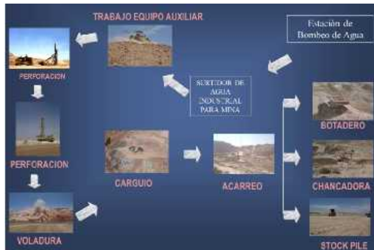
Figura 3: Actividades Unitarias de Minado en Minería de superficie. (Quiquia, 2015)
