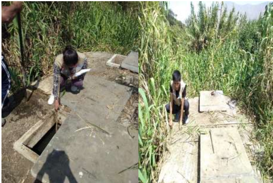
Imagen N° 14: Medición de las dimensiones de tanque de sedimentación.
