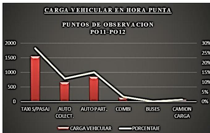
Figura 11: identificó. Carga vehicular Av. Gonzales/ Elaboración propia.
