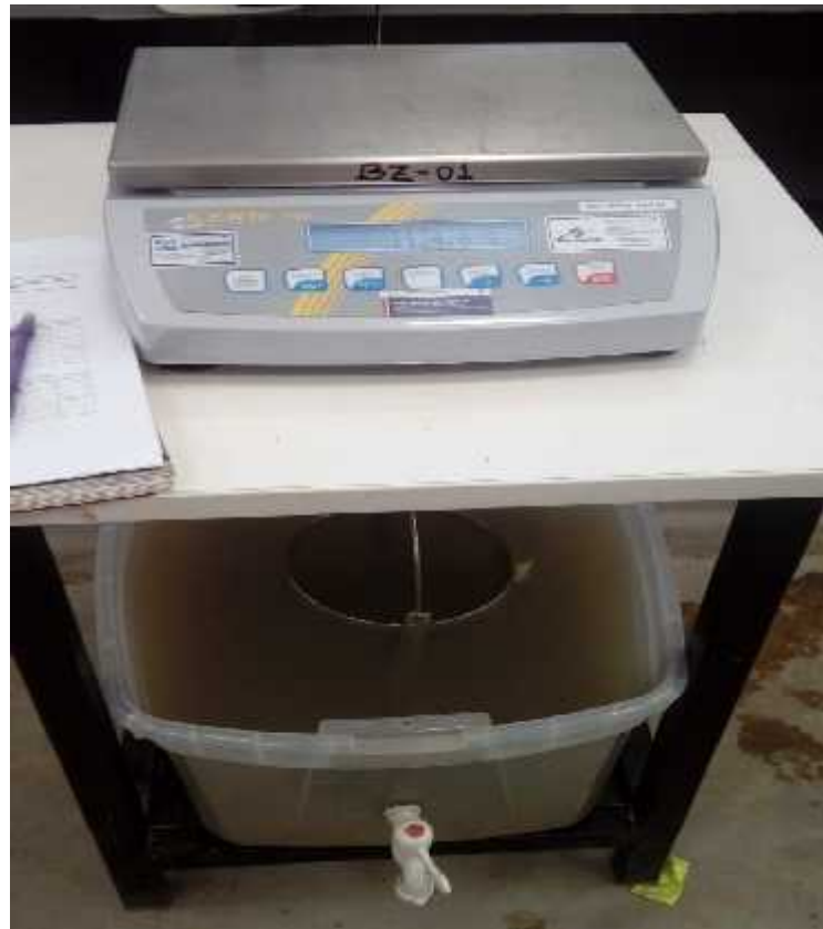
Imagen 17. Peso material saturado superficialmente seca (en agua).
