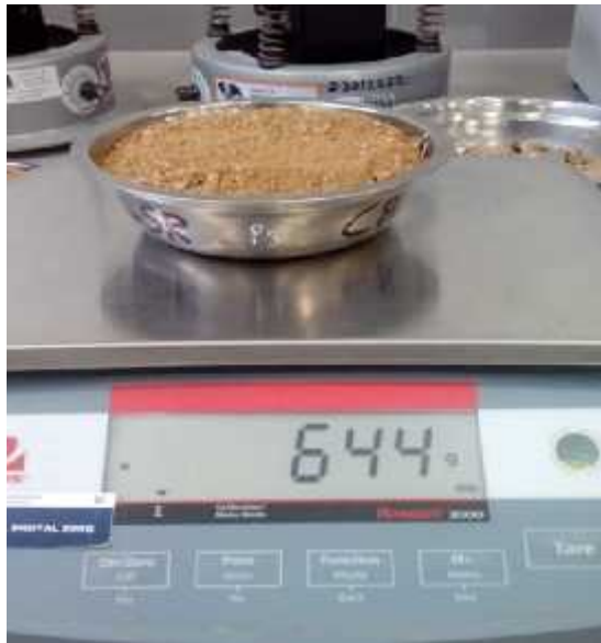
Imagen 10. Peso del agregado superficialmente seca.
