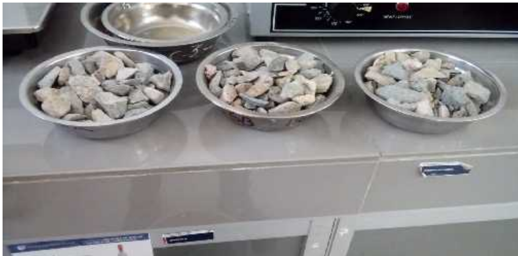
Imagen 11. Tres muestras para el contenido de humedad del agregado grueso.
