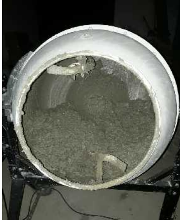
Imagen 26. Trompo de mezcla de concreto.
