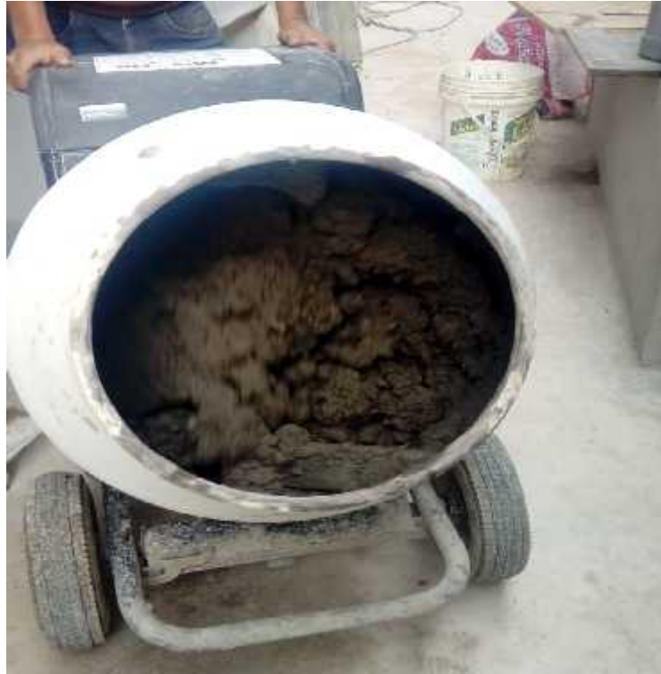
Imagen 18. Mezcla patrón f'c = 210 \text{ kg/cm}^2 .
