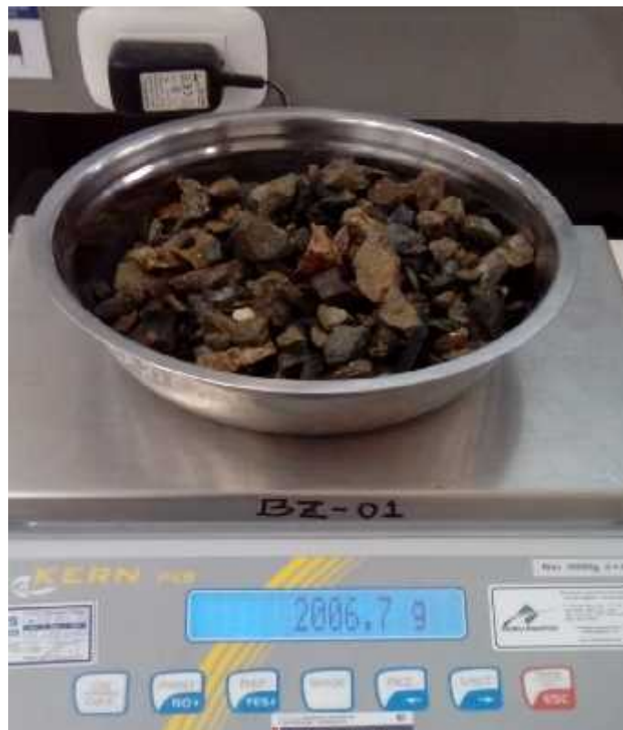
Imagen 16. Peso de la muestra del agregado grueso.
