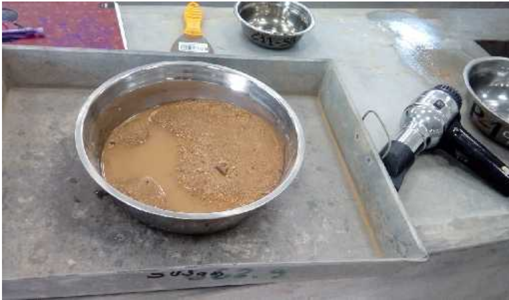
Imagen 12. Muestra saturada del agregado fino.
