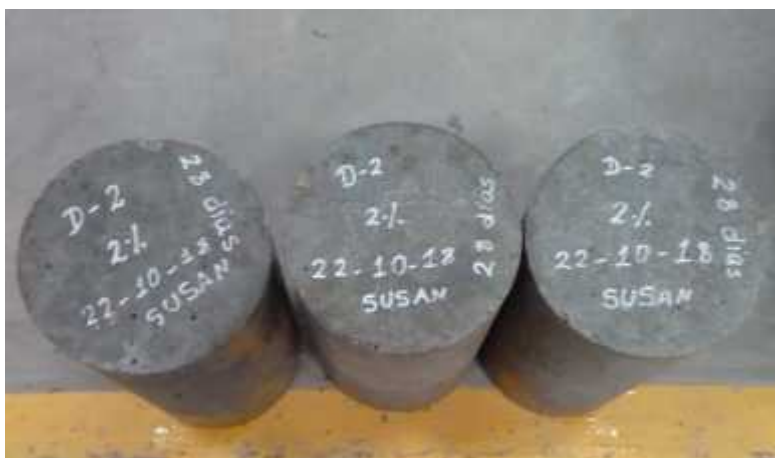
Imagen 42. Rotura de probetas al 2 %.
