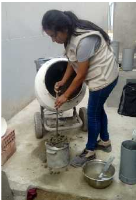
Imagen 22. Compactación de concreto para el peso unitario.
