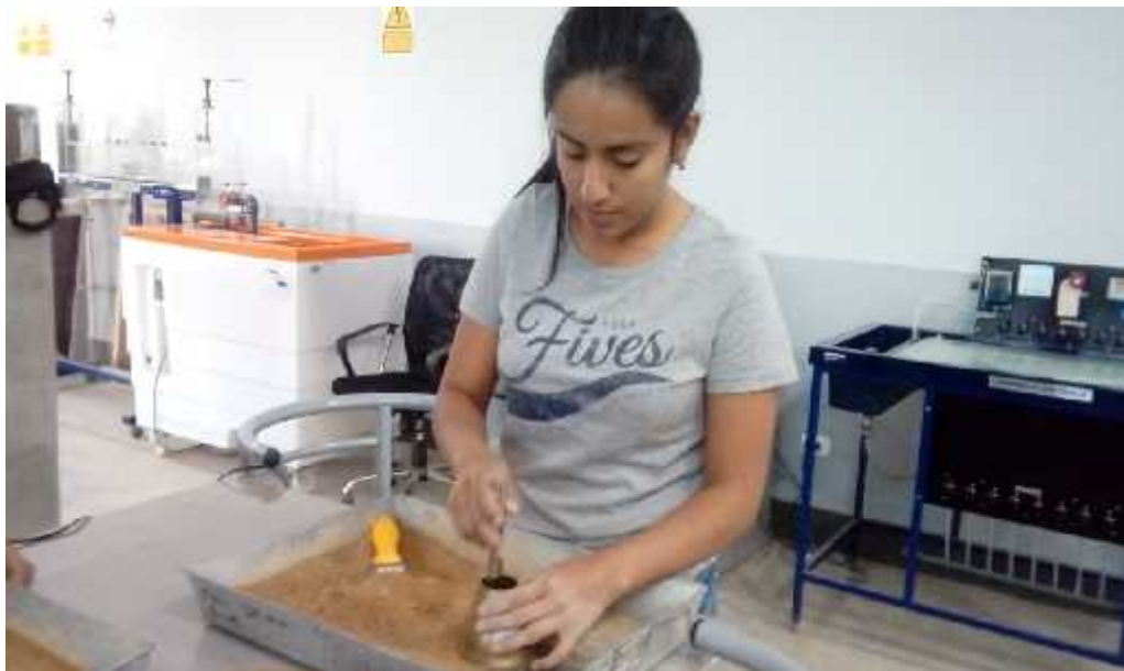
Imagen 13. Compactación del agregado fino en el cono metálico.
