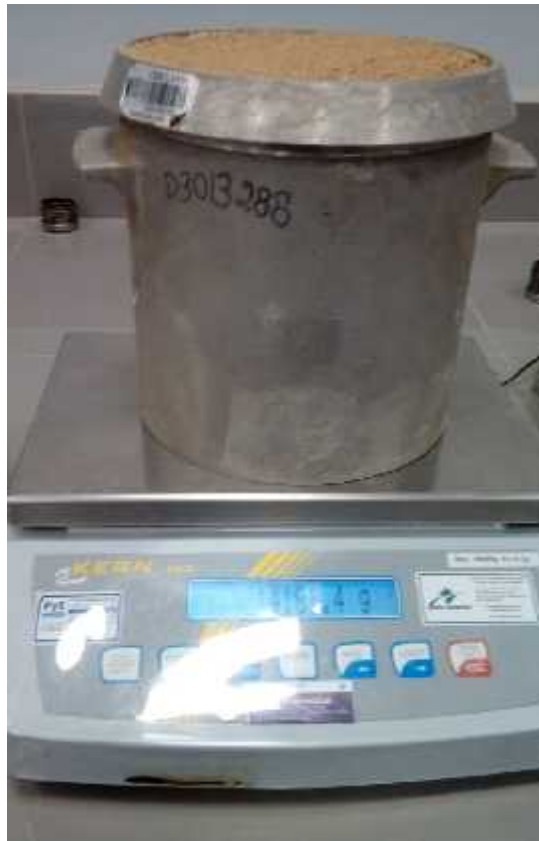
Imagen 4. Peso unitario del agregado fino suelto.
