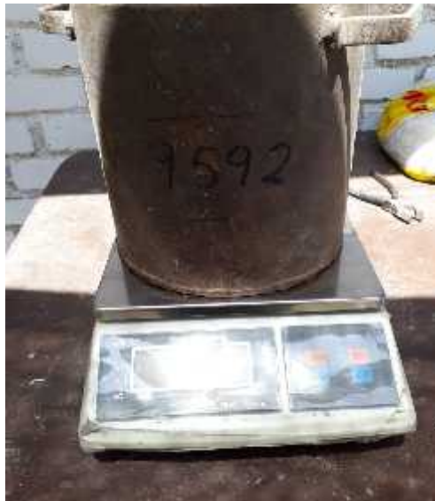
Imagen 30. Peso del concreto con la fibra de las plumas.
