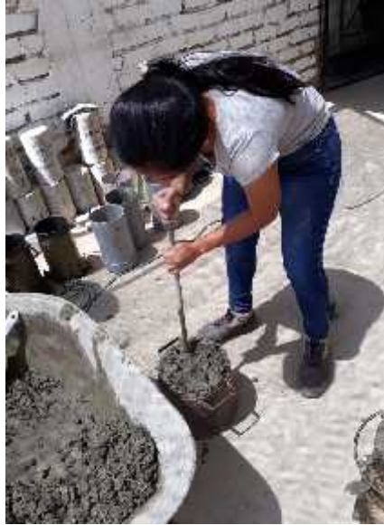
Imagen 29. Peso unitario de la mezcla.
