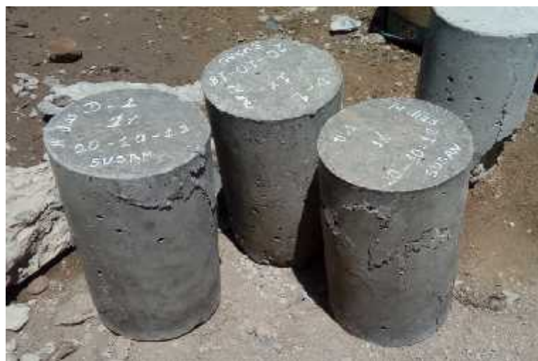
Imagen 41. Rotura de probetas al 1 %.
