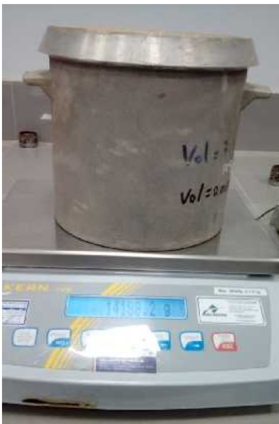
Imagen 5. Peso unitario del agregado fino compactado.
