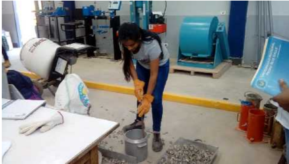
Imagen 7. Compatación del agregado grueso en tres capas.
