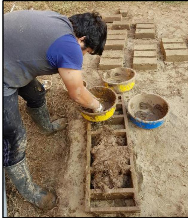
Figura 47. Colocación de mezcla en el molde
