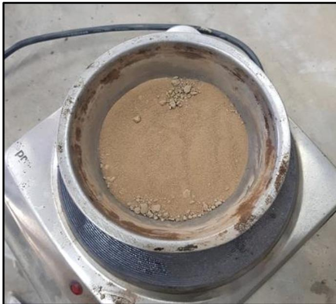
Figura 15. Muestra seca en la prueba de color
