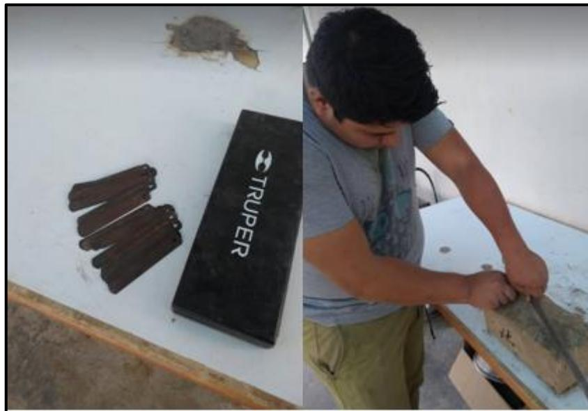
Figura 52. Ensayo de alabeo
