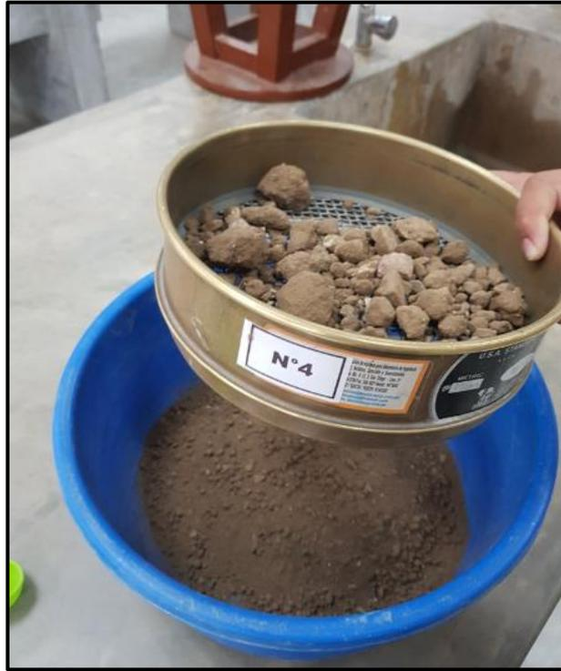
Figura 43. Material tamizado para la elaboración de adobes
