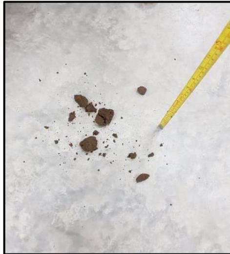
Figura 7. Rotura en la prueba de la bolita
