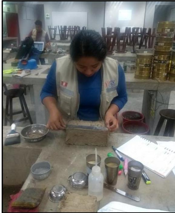
Figura 51. Ensayo de variación dimensional
