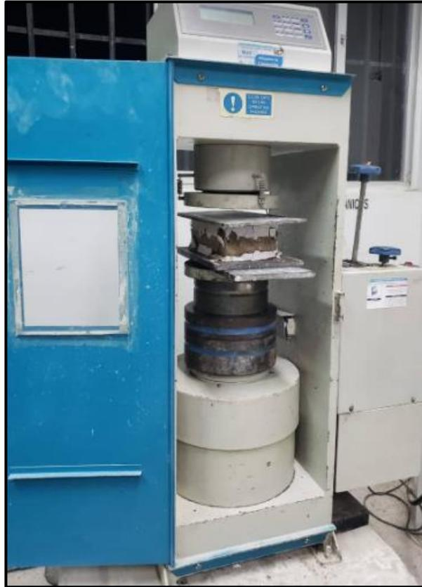
Figura 53. Ensayo de compresión del adobe
