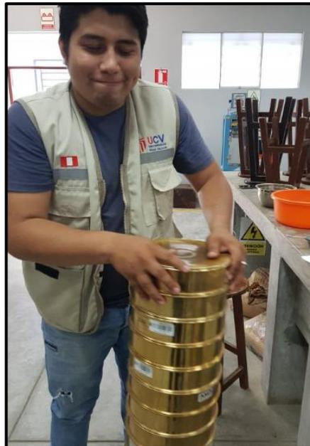
Figura 18. Ensayo de granulometría por tamizado
