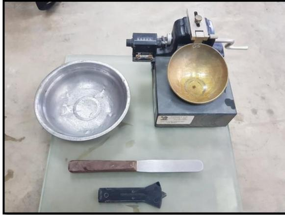
Figura 20. Instrumentos para el ensayo de límite líquido
