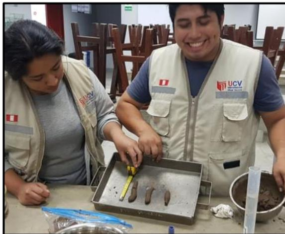
Figura 4. Prueba del rollo
