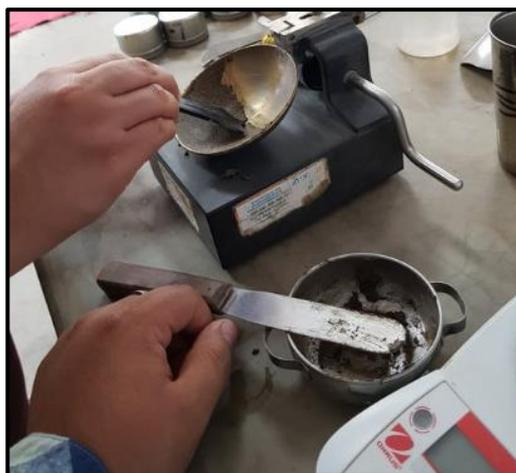
Figura 21. Ensayo de límite líquido (Copa de Casagrande)
