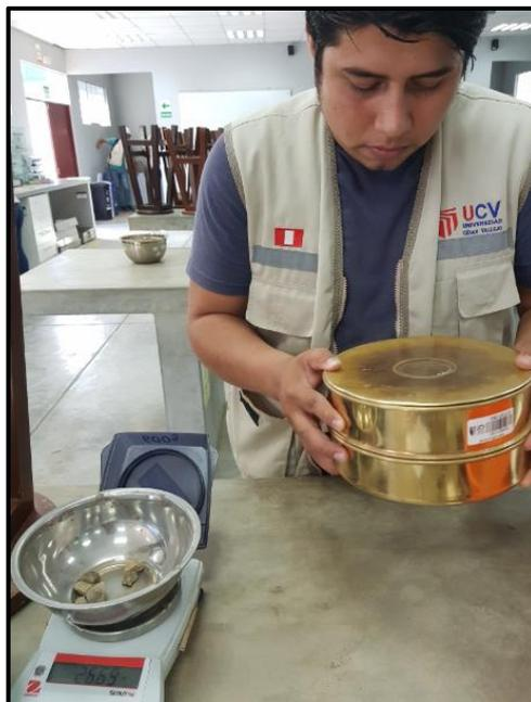
Figura 40. Pesar material retenido en cada tamiz
