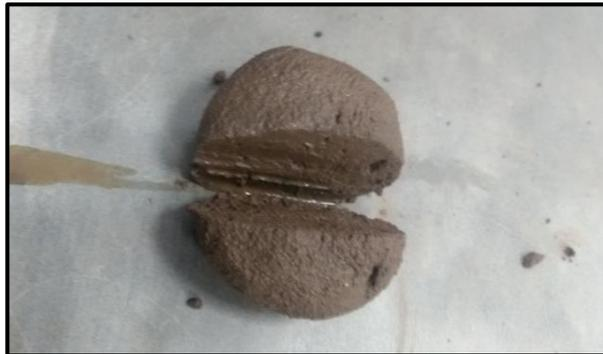
Figura 11. Prueba de corte de cuchillo
