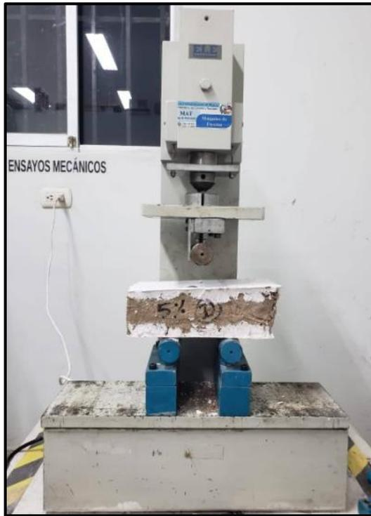
Figura 55. Ensayo de flexión del adobe
