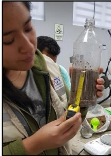
Figura 9. Prueba de la botella, material hasta la mitad de la botella
