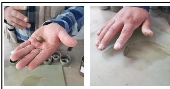
Figura 22 Ensayo de límite plástico
