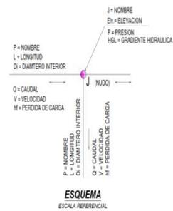
ESQUEMA DE MODELACION HIDRAULICA - AGUA POTABLE
