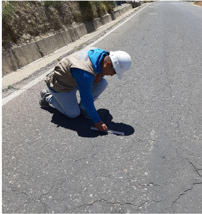
Descripción: Medida de falla con regla milimetrada
