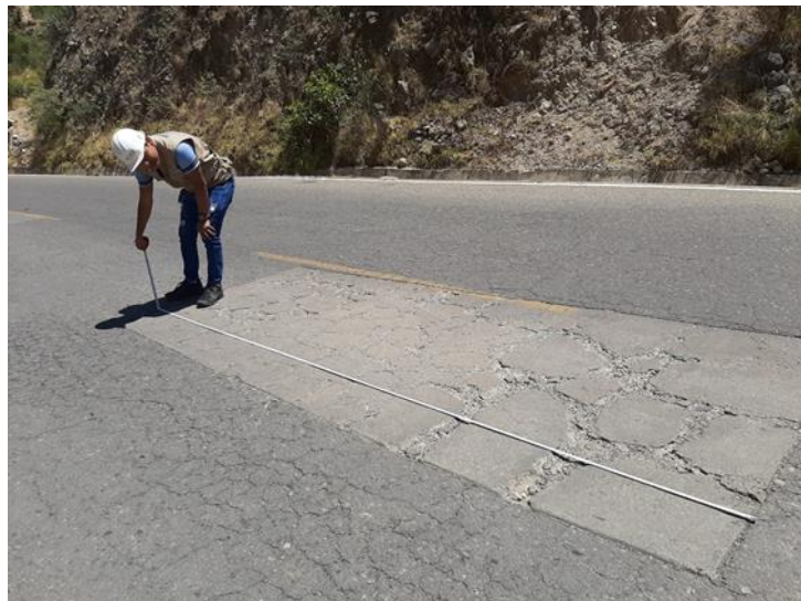
Descripción: Medida de falla de parcheo con wincha
