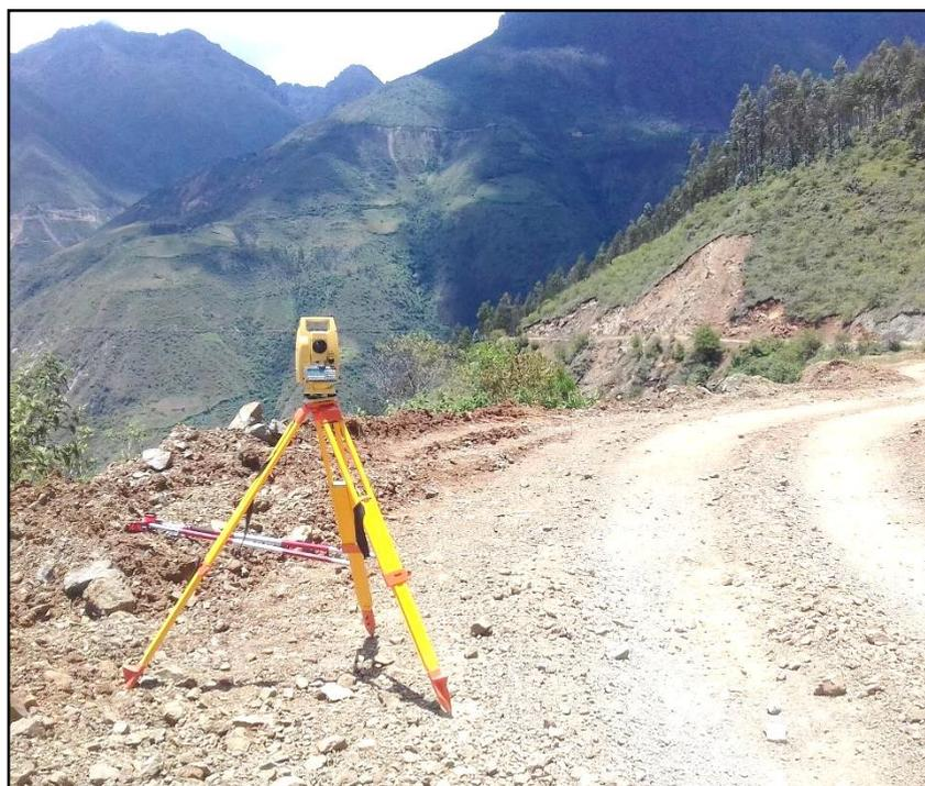
**Foto:** Realizando el levantamiento del camino vecinal
