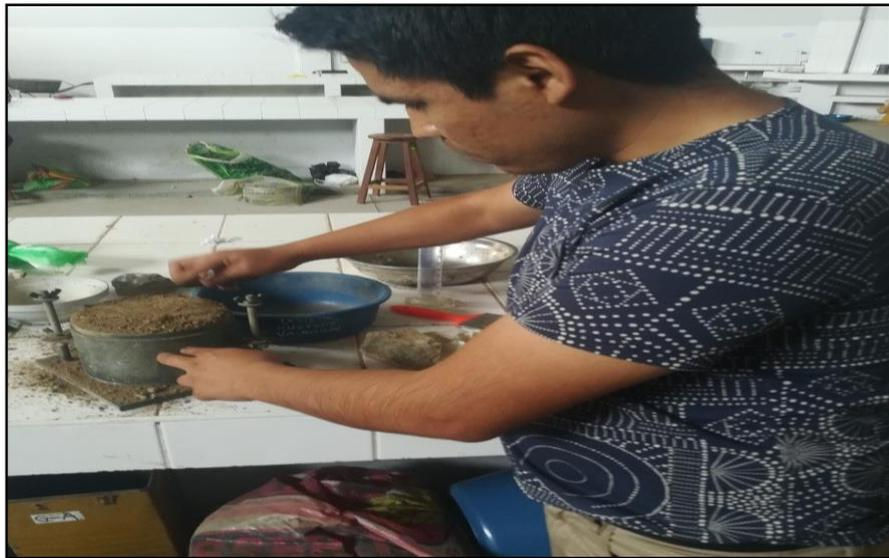
**Foto 02:** Realizando el emparejamiento de la muestra en el molde CBR
