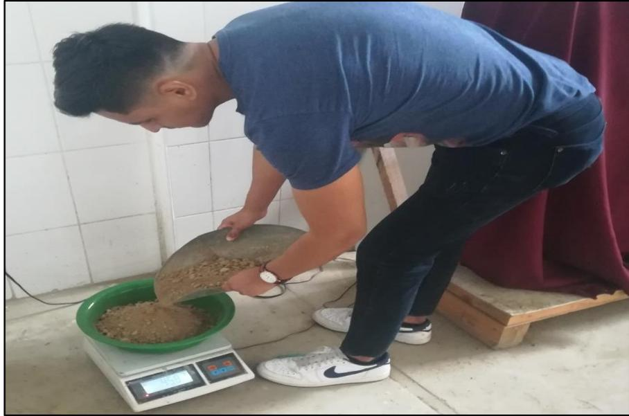
**Foto 03:** Pesando la muestra de los tamices
