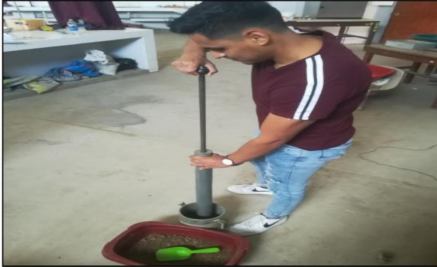
**Foto 01:** Realizando los golpes con el pisón de compactación para CBR
