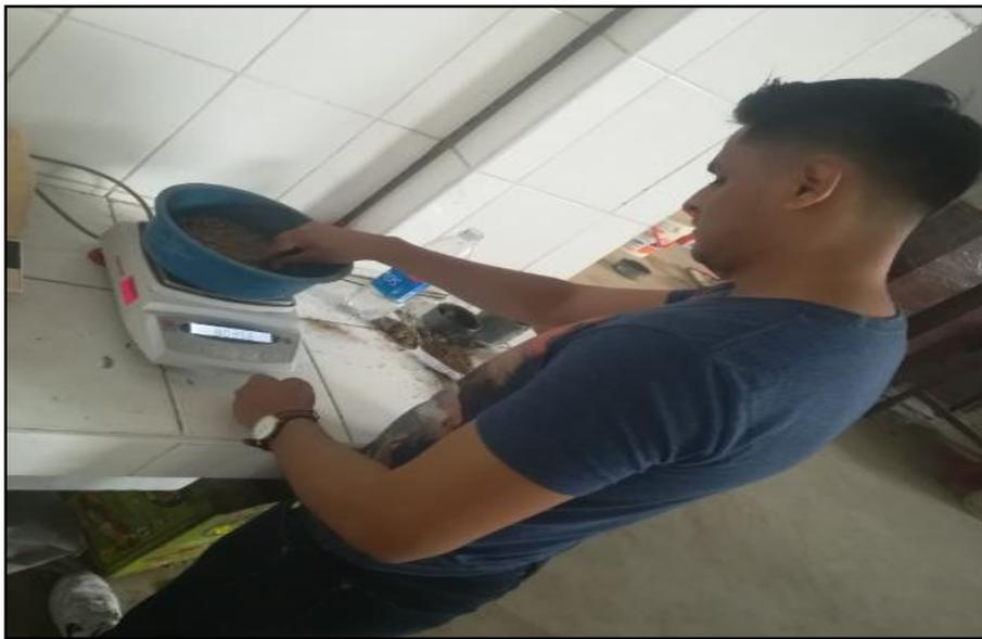
**Foto 04:** Pesando la muestra de los tamices
