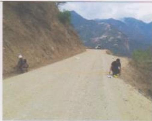
FOTO N° 04: Realizando la medición del ancho de la calzada de la vía en la progresiva Km 1+500
