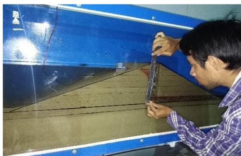
**Ilustración 109:** Medida vertical de la línea de infiltración de la presa con filtro.
