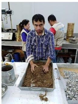
*Ilustración 71:* Incorporación de agua a la muestra de suelo.
