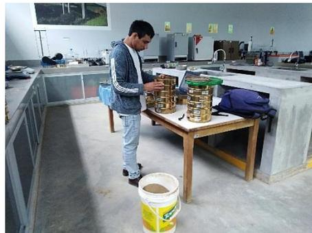
**Ilustración 28:** Tamizado del material.
