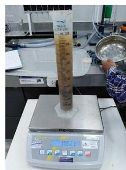
*Ilustración 67:* Peso para posterior agitación.
