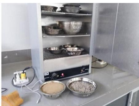
*Ilustración 30:* Secado en horno.
