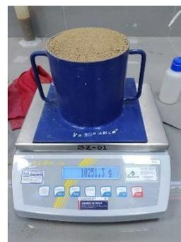
*Ilustración 63:* Pesado del material compactado.
