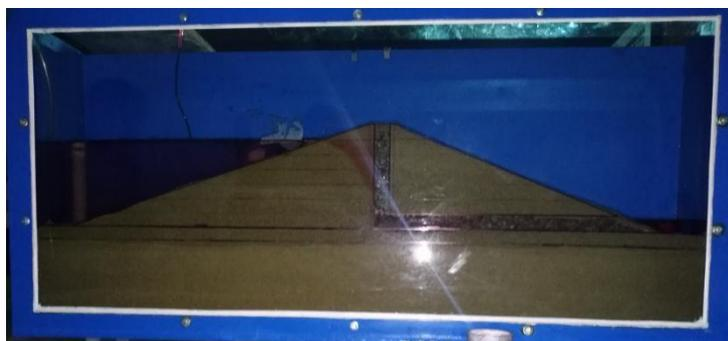
**Ilustración 108:** Línea de infiltración modelo físico, presa con filtro.
