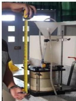
*Ilustración 74:* Toma de la altura del permeámetro.
