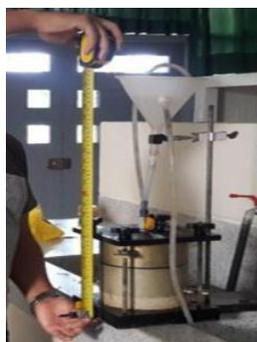
*Ilustración 43:* Toma de la altura del permeámetro.
