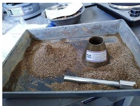
*Ilustración 65:* Verificación del estado de humedad del material.
