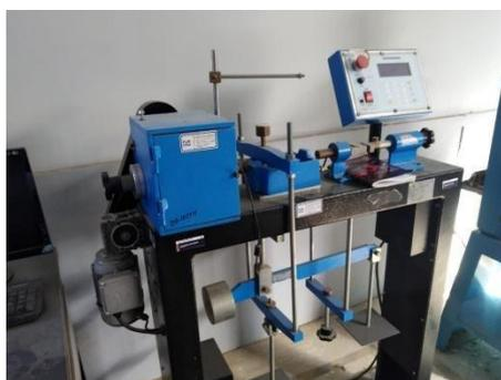
**Ilustración 76:** Imagen de referencia del ensayo de corte directo.
