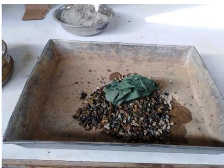
**Ilustración 21:** Secado superficial del material.
