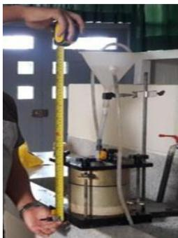
*Ilustración 23:* Toma de la altura del permeámetro.
