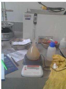
*Ilustración 40:* Incorporación de agua hasta el menisco de la fiola.
