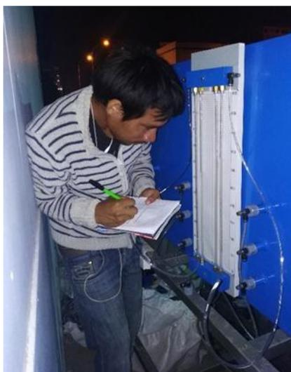
**Ilustración 106:** Toma de datos de los piezómetros.
