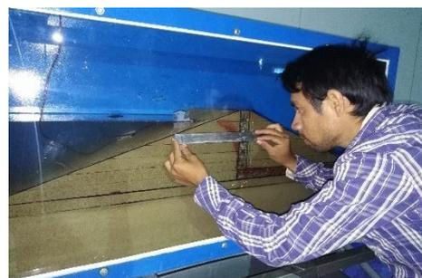
**Ilustración 110:** Medida horizontal de la línea de infiltración de la presa con filtro.
