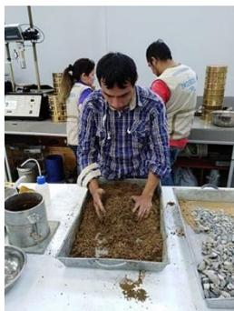
**Ilustración 41:** Incorporación de agua a la muestra de suelo
