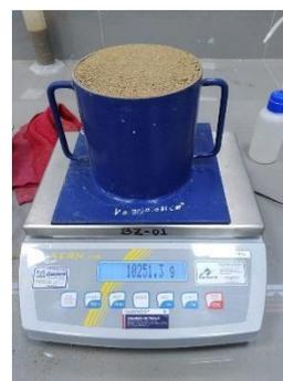
**Ilustración 32:** Pesado del material compactado.
