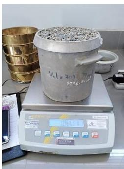
**Ilustración 20:** Pesado del material suelto.
