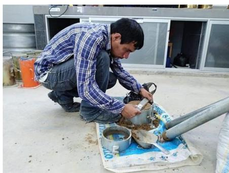
*Ilustración 73:* Nivelación del material en el molde cilíndrico.
