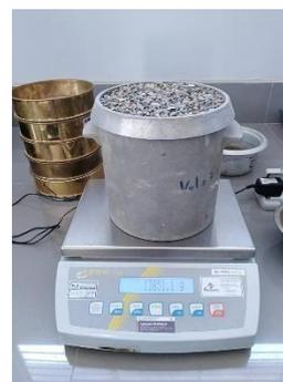
**Ilustración 19:** Pesado del material compactado.
