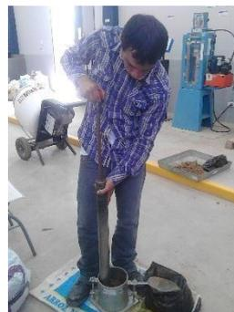
**Ilustración 42:** Apisonado de la muestra dentro del molde cilíndrico.
