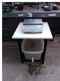
**Ilustración 22:** Canastilla y material sumergidos en agua.
