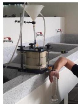
*Ilustración 44:* Toma de caudal del permeámetro.
