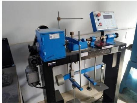
**Ilustración 25:** Imagen de referencia del ensayo de corte directo.
