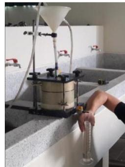
*Ilustración 75:* Toma de caudal del permeámetro.
