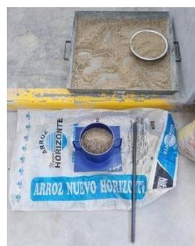
*Ilustración 61:* Varillado del material.
