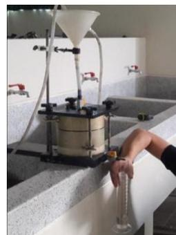
*Ilustración 24:* Toma de caudal del permeámetro.
