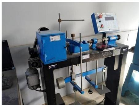
**Ilustración 45:** *Imagen de referencia del ensayo de corte directo.*
