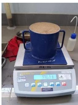
**Ilustración 33:** Pesado del material suelto.
