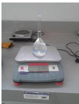
*Ilustración 38:* Calibración de la fiola.
