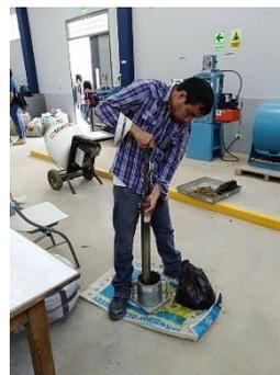
*Ilustración 72:* Apisonado de la muestra dentro del molde cilíndrico.
