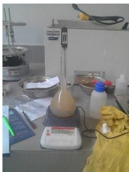
*Ilustración 70:* Incorporación de agua hasta el menisco de la fiola.
