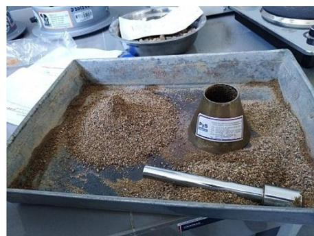
*Ilustración 35:* Verificación del estado de humedad del material.
