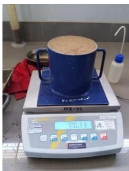
*Ilustración 62:* Pesado del material suelto
