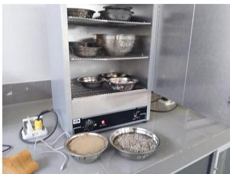
*Ilustración 17:* Secado del confitillo en el horno.
