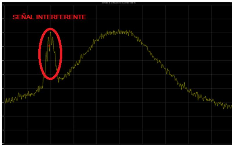
Figura 3. Interferencia de radio pirata FM a señal de radio FM autorizada
