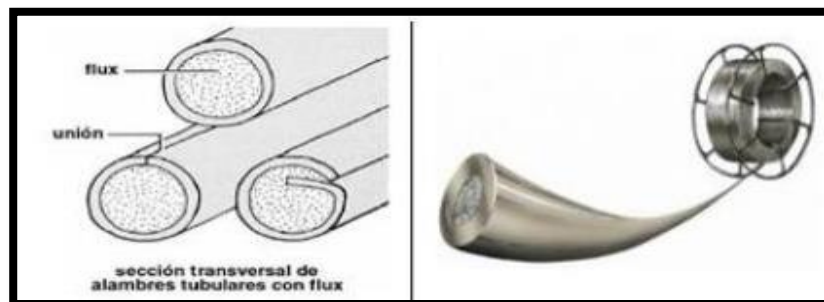
Figura 2: Alambre tubular para proceso de soldadura FCAW
