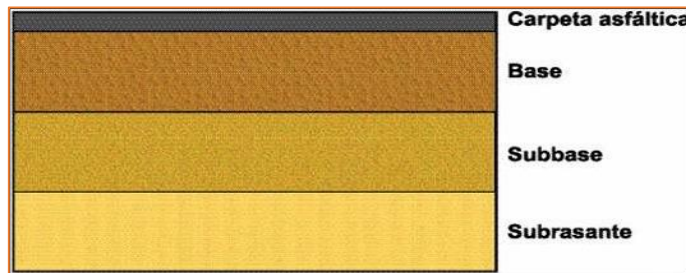
Figura 1. Estructura del pavimento flexible.
