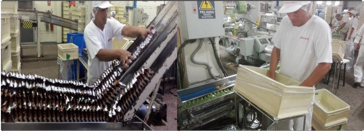
Figura 20. Alimentación de galletas a envasadoras
