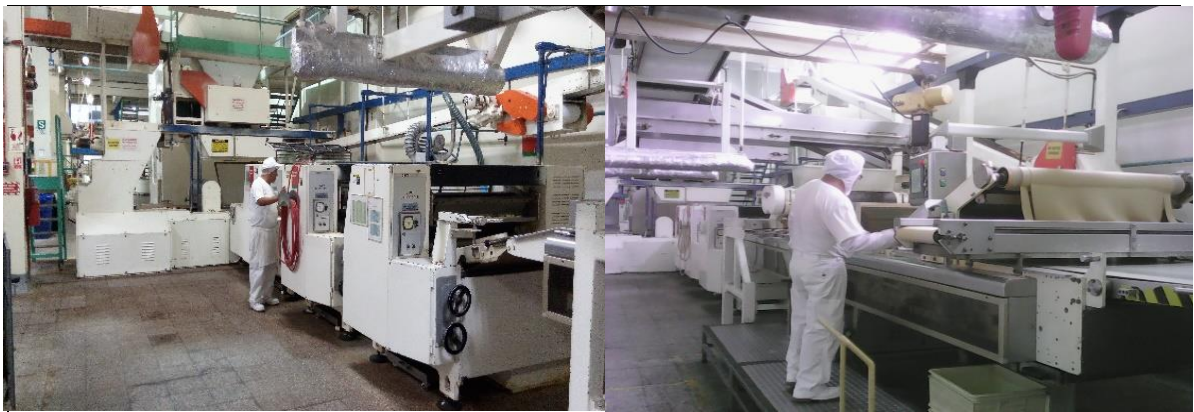
Figura 16. Laminado y formado de galletas
