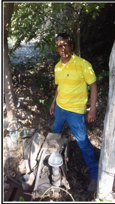
Motobomba de 20 HP existente en el Fundo.
