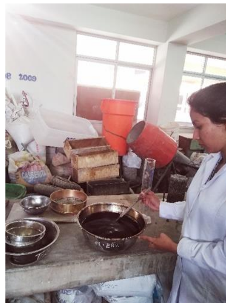
Imagen Nº11: Lavado del asfalto para luego tamizar.
