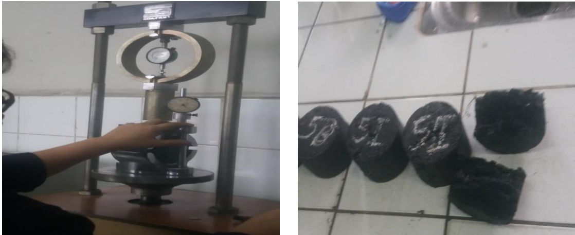
Imagen N°13: Se realiza la prueba en el equipo Marshall
