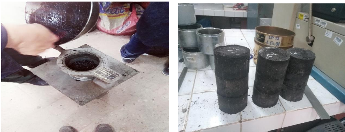
Imagen N°12: Mezclado de la carpeta asfáltica agregada cal para realizar las briquetas.
