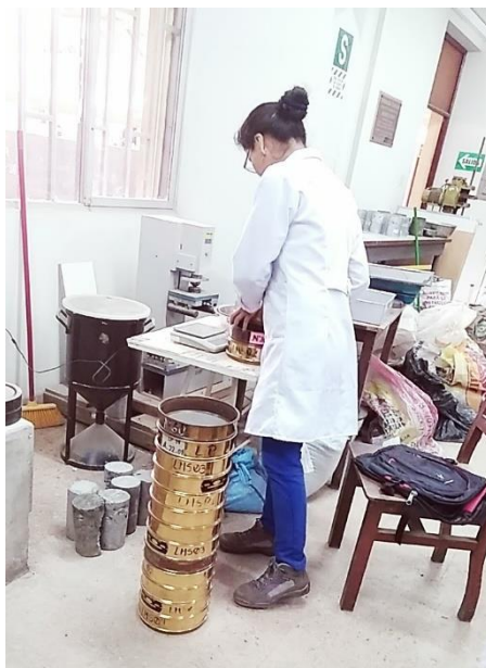
Imagen Nº11: Lavado del asfalto para luego tamizar.
