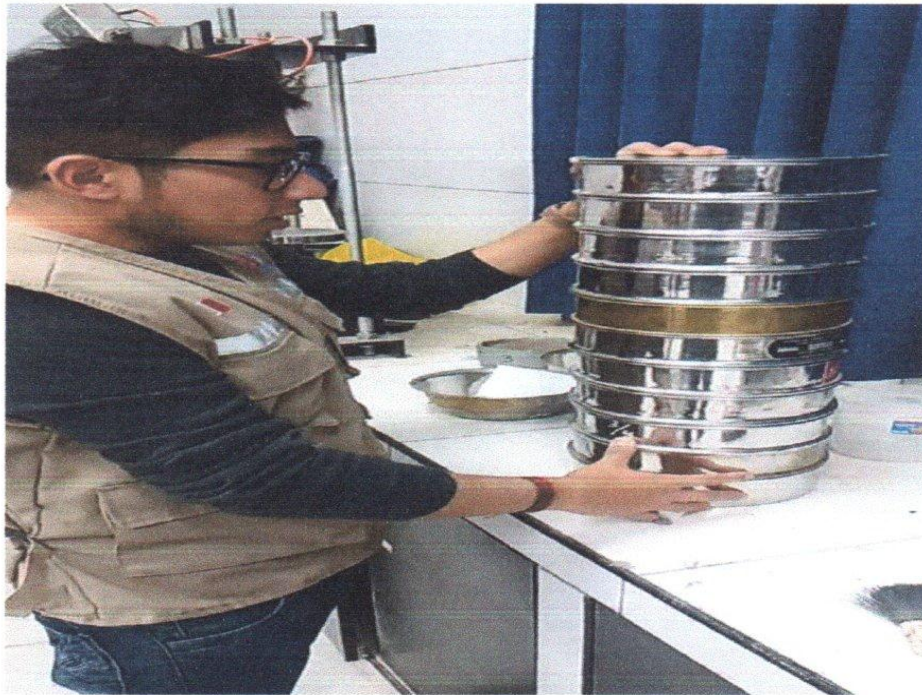
En la imagen se observa introducción de la muestra a los tamices, para su tamizado en un tiempo de 20 a 25 minutos.
