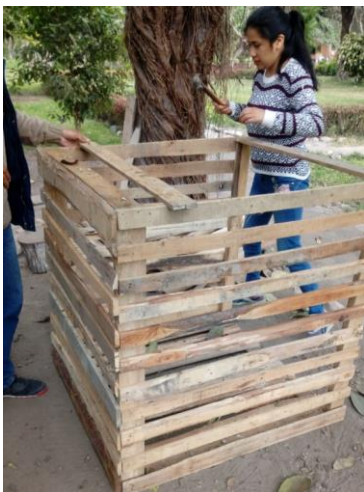
Figura 5: Elaboración de cajas de 1m 3
