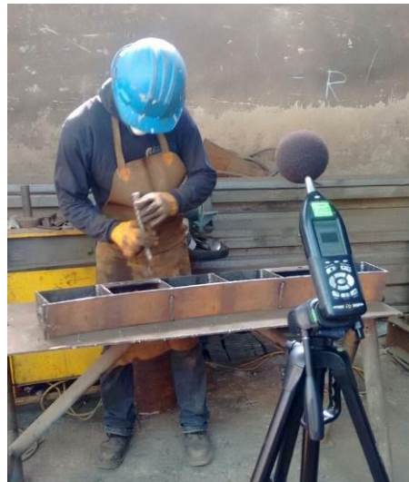
Figura 15. Perforación. Se aprecia perforación por golpe, altos niveles de ruido, pero de breve duración. Adaptación propia, 2017.
