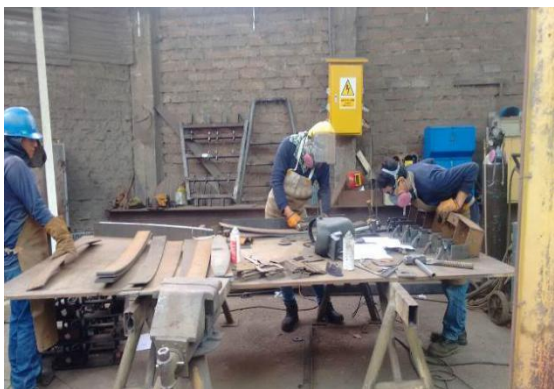
Figura 18. Corte y armado En esta área el uso de soldadura y amoladora es la fuente generadora ni niveles altos de ruido. Adaptación propia, 2017.
