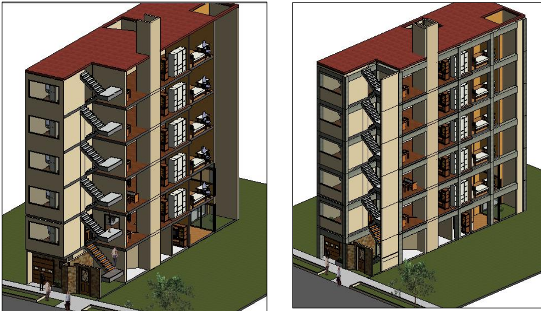
Figura 55 Modelos paramétricos BIM. Integrados: Arquitectura y Estructura.
