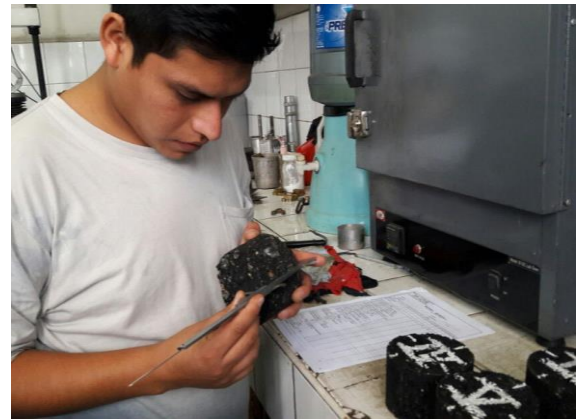
Figura 72: Determinación del volumen de las briquetas
