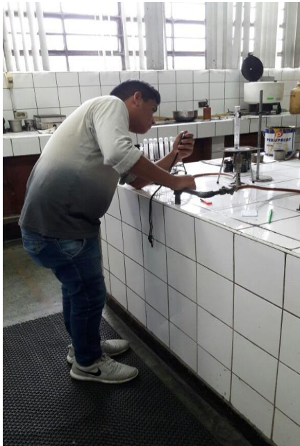
Figura 51: Ensayo de penetración 25°C
