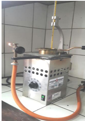
Figura 06: Ensayo Punto de Inflamación.
