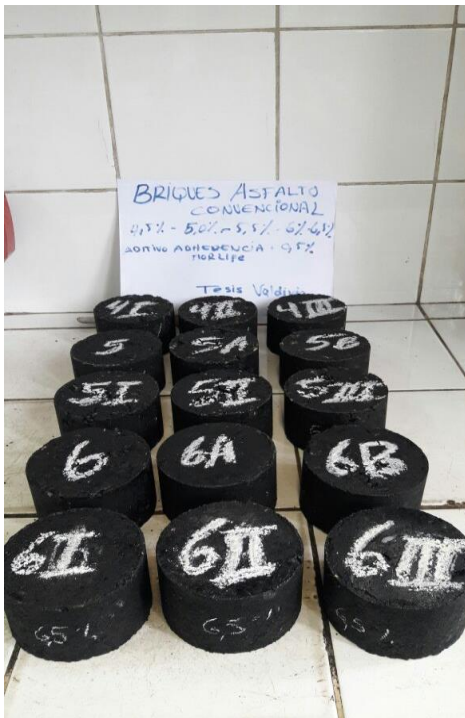
Figura 61: Briquetas de la mezcla convencional
