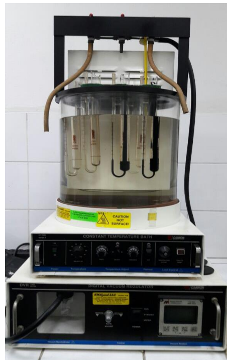
Figura 52: Ensayo de viscosidad
