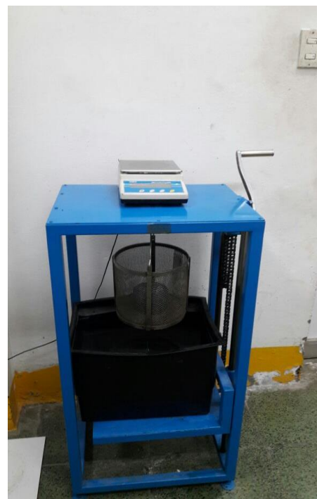
Figura 64: Determinando gravedad específica de las briquetas
