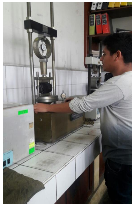
Figura 76: Rotura de briquetas por tracción
