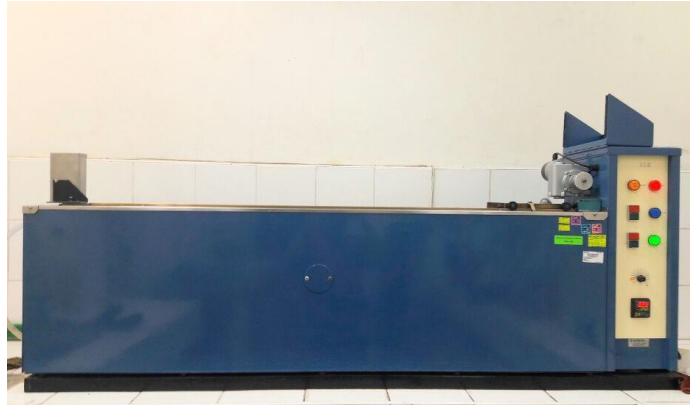
Figura 05: Equipo para el ensayo de ductilidad
