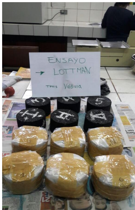
Figura 75: Disposición de briquetas para la alteración de temperaturas
