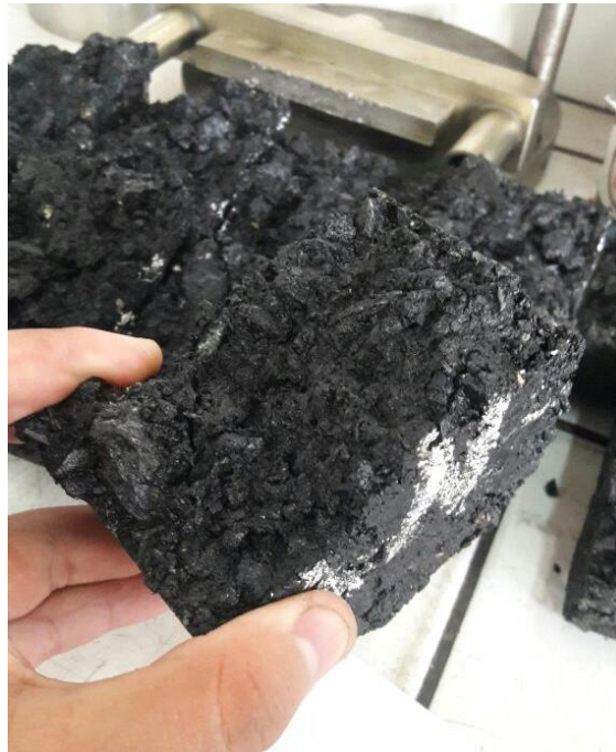
Figura 77: Briqueta ensayada de la mezcla convencional
