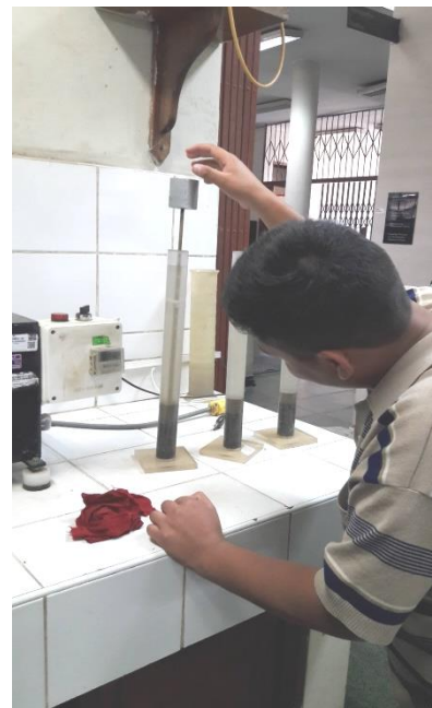
Figura 48: Medición de altura de finos
