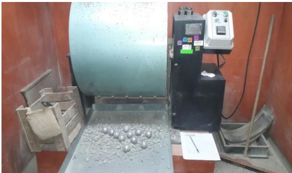
Figura 43: Ensayo Los Ángeles
