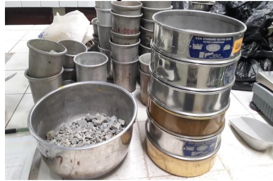
Figura 40: Granulometría de agregado grueso
