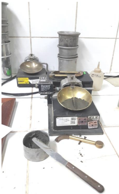
Figura 47: Determinando limite liquido (Copa Casagrande)
