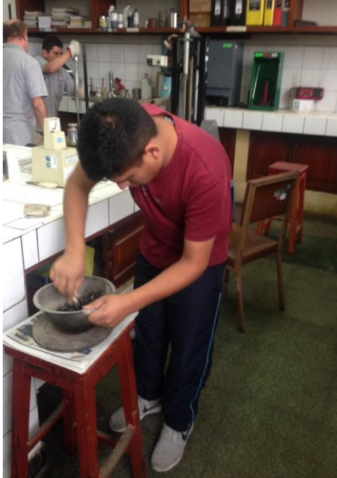
Figura 57: Mezclado de agregados más bitumen
