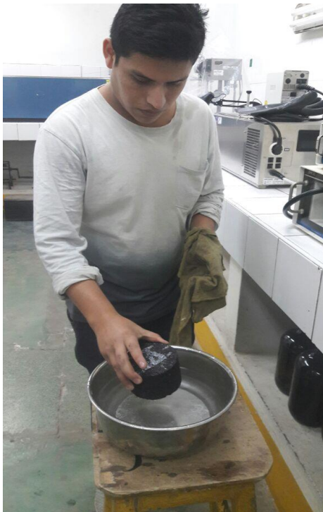
Figura 71: Saturación de broquitas para el ensayo TSR
