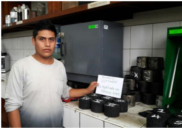
Figura 71: Saturación de broquitas para el ensayo TSR
