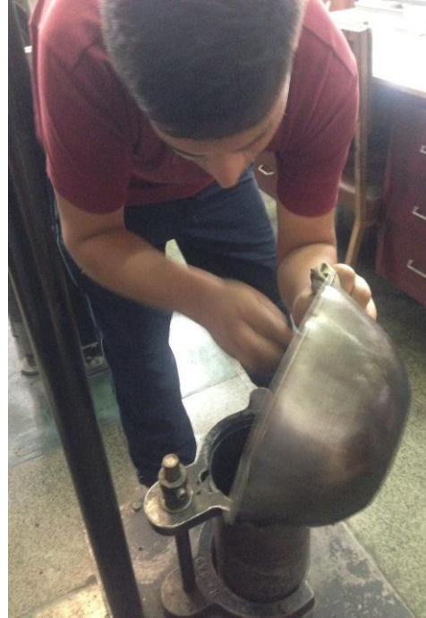
Figura 60: Extracción de las briquetas
