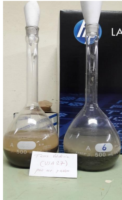
Figura 48: Medición de altura de finos
