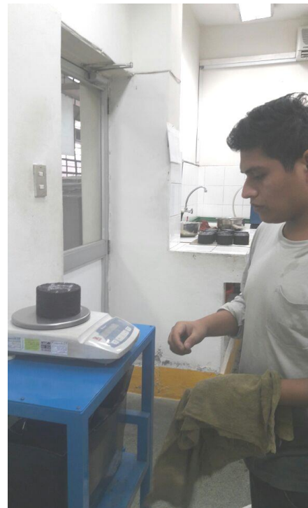
Figura 72: Determinación del volumen de las briquetas
