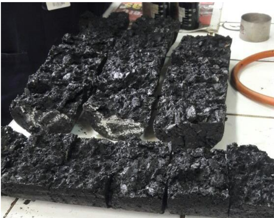
Figura 78: Briquetas ensayadas de la mezcla modificada con polímeros SBS (Betutec IC)
