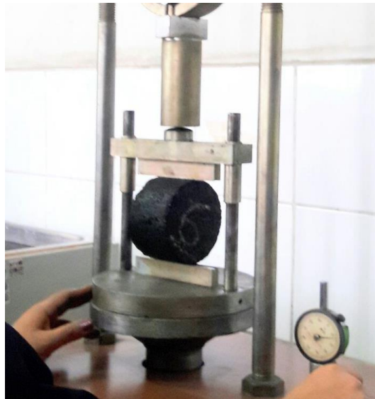
Figura 08: Ensayo de tracción directa
