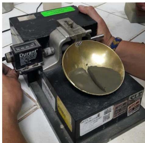
Figura 07: Muestra del ensayo Casagrande
