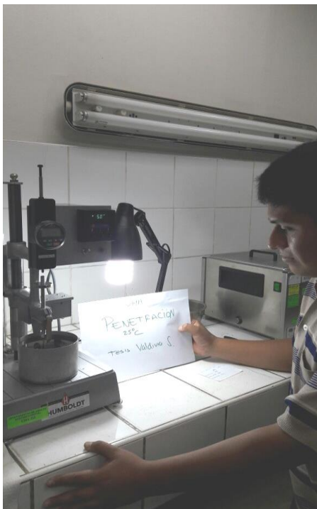
Figura 51: Ensayo de penetración 25°C
