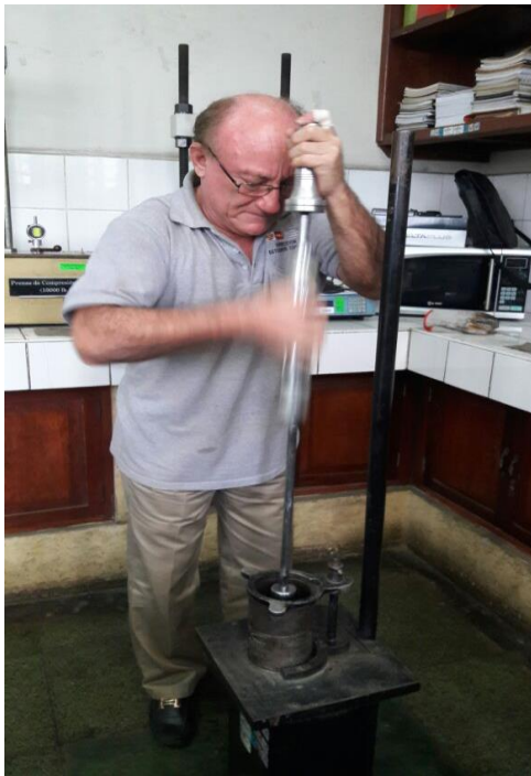
Figura 59: Compactación de mezclas asfálticas
