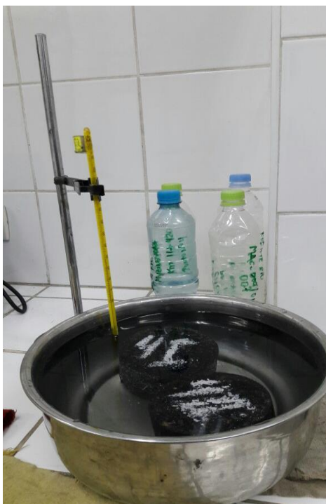
Figura 63: Saturación de briquetas a 25°C
