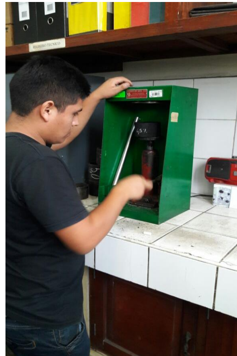
Figura 60: Extracción de las briquetas
