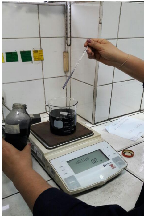
Figura 55: Adición del aditivo de adherencia
