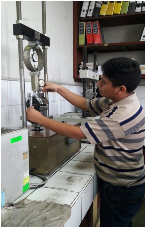
Figura 67: Rotura de las briquetas
