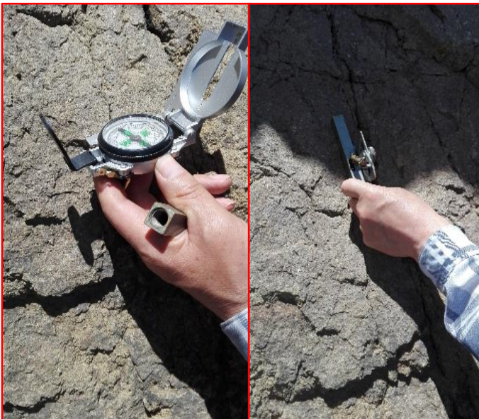
Fotografía 03: midiendo el buzamiento y el rumbo del talud, a la izquierda la brújula y a la derecha el eclímetro.
