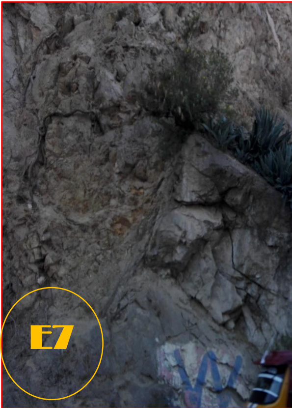
Fotografía 12: Sectorización por niveles de vulnerabilidad, características físicas y mecánicas del macizo rocoso, se visualiza la estación E7, se visualiza el macizo rocoso disgregado por diaclasas continuas y con una falla por volcamiento.
