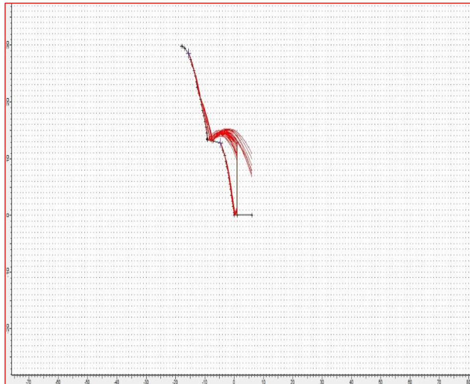
Figura 11: Modelamiento de caída de rocas en la E2 en el Software Rocfall.
