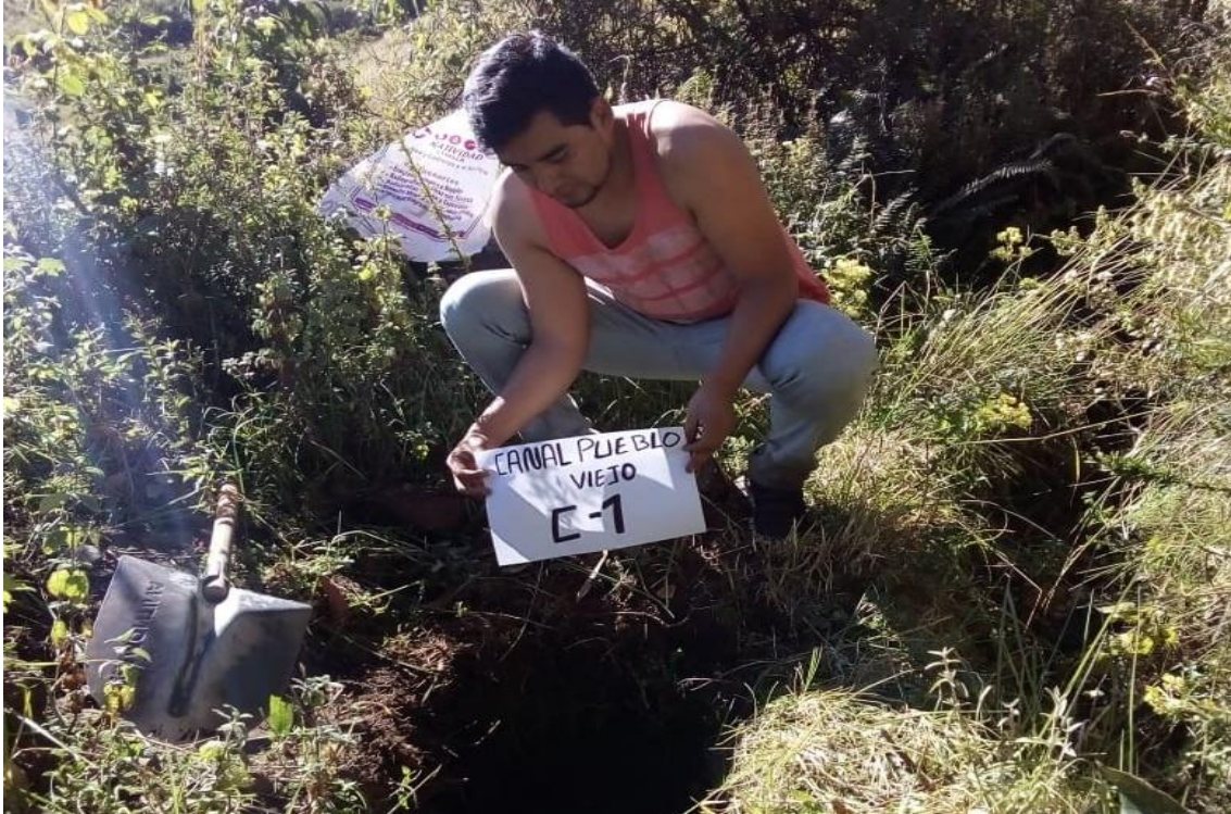
Estudio de mecánica de suelos: Calicata 1
