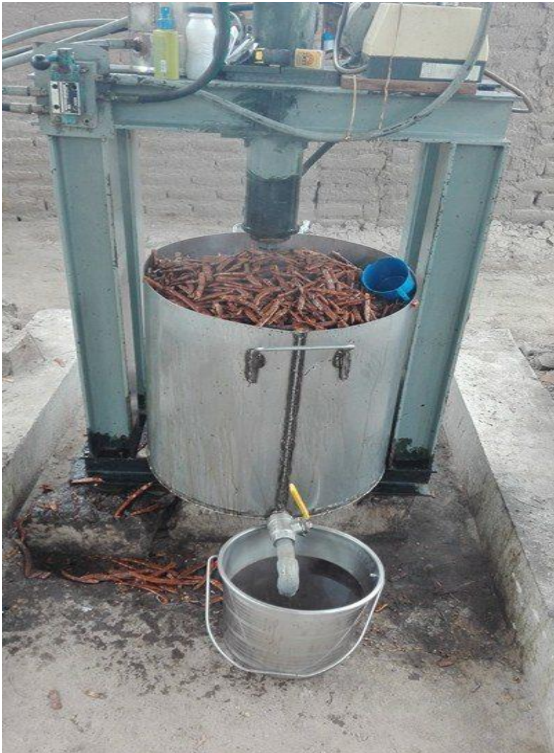
Figura 12: Etapa extracción del extracto algarroba
