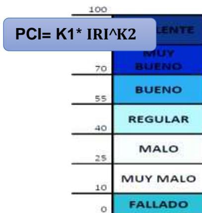
ENTONCES **SEGÚN EL ÍNDICE DE CONDICIÓN DEL PAVIMENTO (PCI) EL ESTADO DEL PAVIMENTO ES:**
