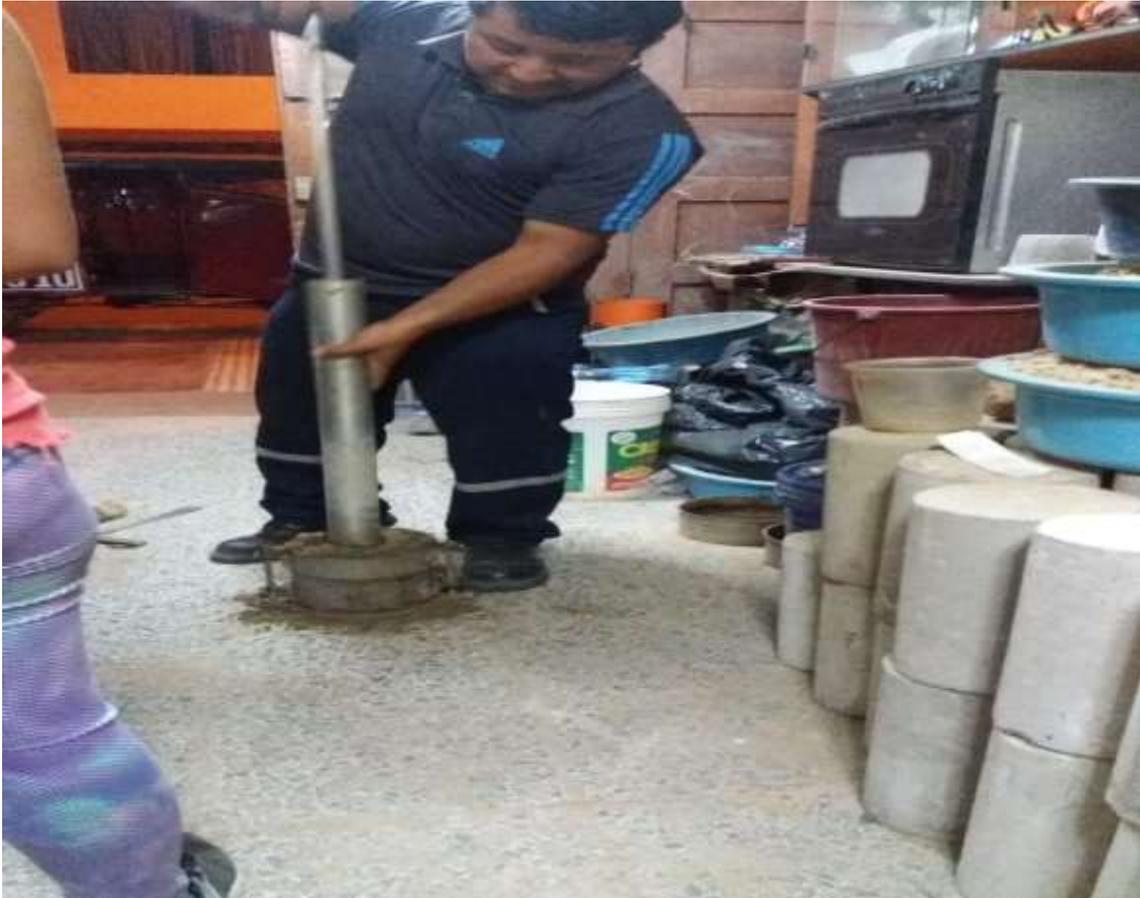
**Colaborador del laboratorio realizando el ensayo de Próctor Modificado según el MTC – E 115 y el ensayo de CBR según el MTC E – 132**
