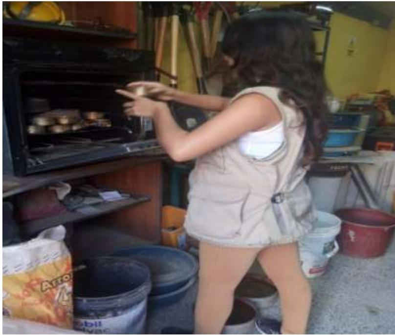
Se colocan las taras en el horno y se deja a secar por 24 horas a una temperatura de  $110^{\circ}\text{C}$  según MTC E-108
