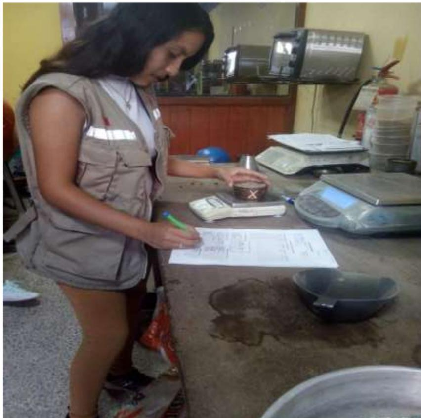
Realizando el ensayo de contenido de humedad del suelo de las calles 3 y 4 de la
