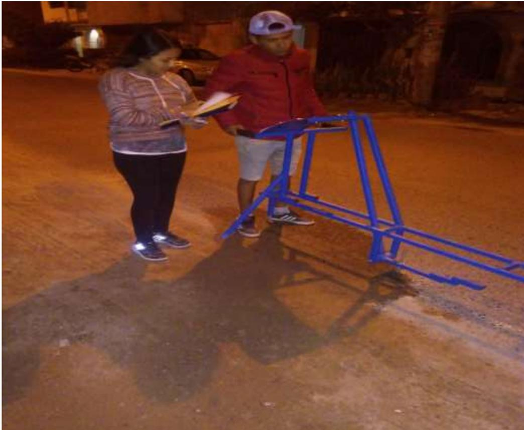
**Tomando nota de los datos del ensayo con el rugosímetro de Merlín en el pavimento.**
