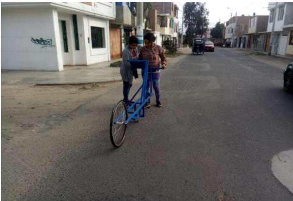
**Llenando ficha técnica con los datos de ensayos con el rugosímetro de Merlín en el pavimento flexible en la calle 3 de Urbanización Nicolás de Garatea.**
