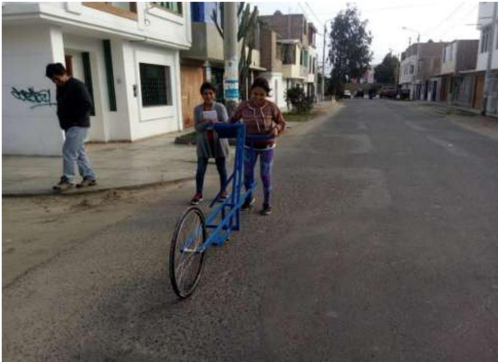
**Tesista realizando ensayos con el rugosímetro de Merlín en el pavimento flexible en la calle 4 de Urbanización Nicolás de Garatea.**
