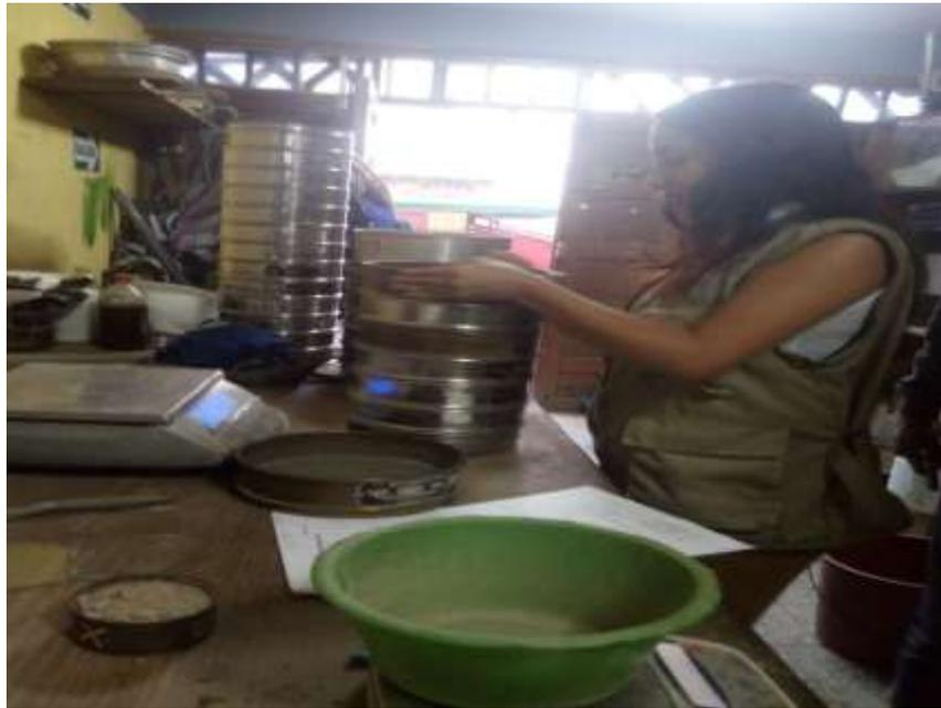
En el laboratorio realizando el análisis granulométrico de las muestras del suelo.
