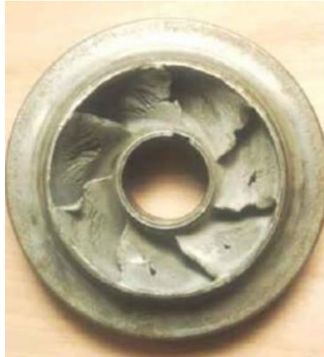
Figura 7: Rodete dañado por cavitación
