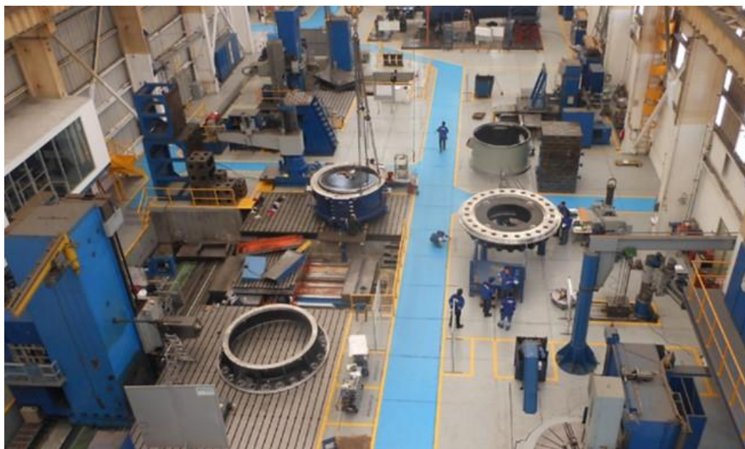
Figura 2: Taller de reparación de rodete de la empresa Andritz Hydro - México
