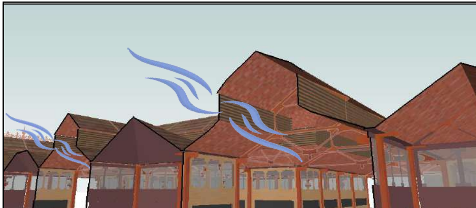
VENTILACIÓN POR MEDIO DE LOS TECHOS DEL MERCADO SAN MIGUEL
