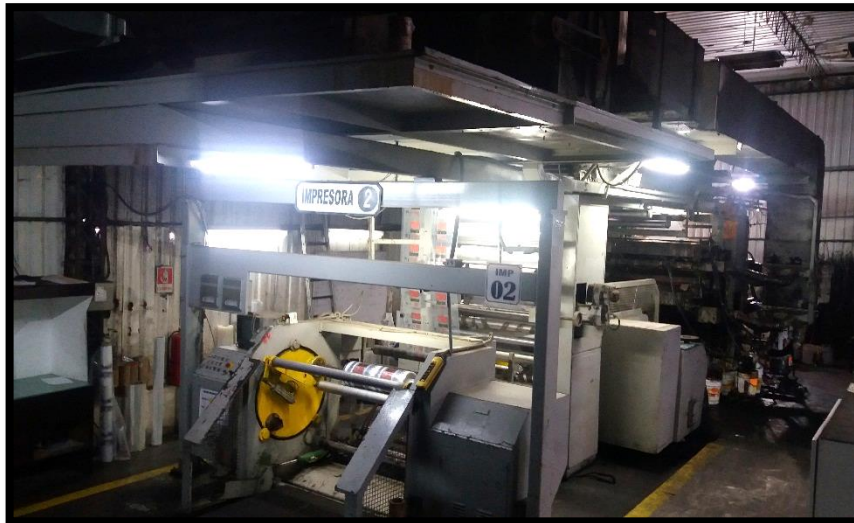
FIGURA N° 36: Impresora N°2 - FLEXOTECNICA (Italia) - 6 colores
