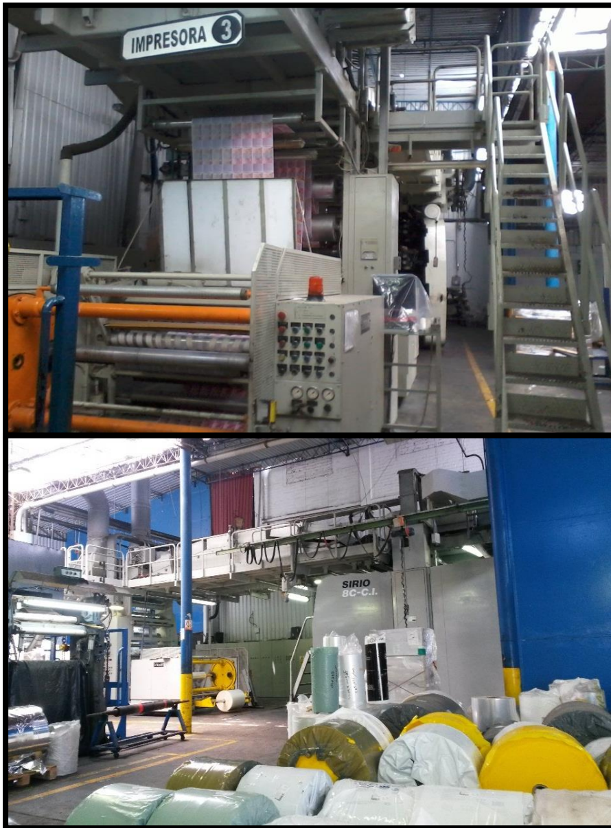
FIGURA N° 37: Impresora N°3 - SCHIAVI (Brasil) - 8 colores
