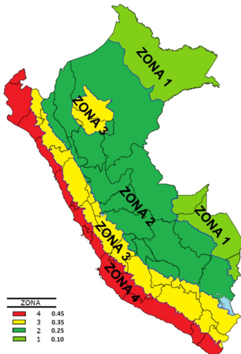
A cada zona se asigna un factor Z según se indica en la tabla. Este factor se interpreta como la aceleración máxima horizontal en suelo rígido con una probabilidad de 10 % de ser excedida en 50 años. El factor Z se expresa como una fracción de la aceleración de la gravedad.
