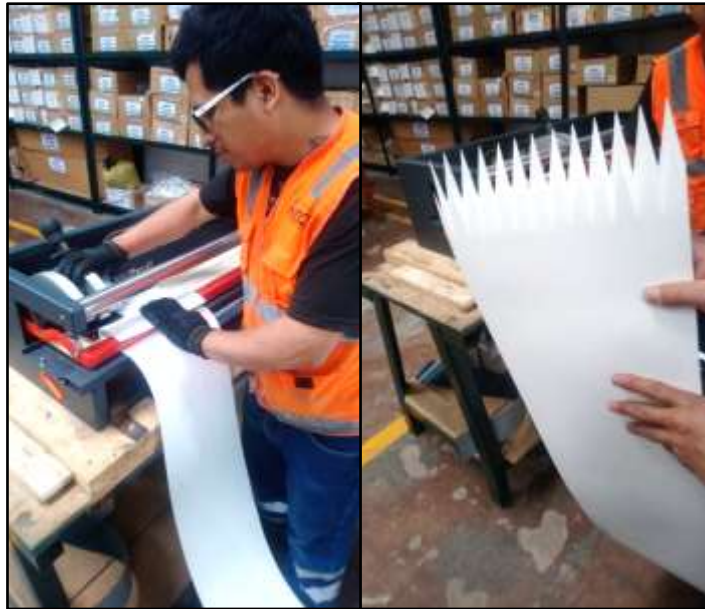
Figura 38: Troquelado de la faja transportadora
