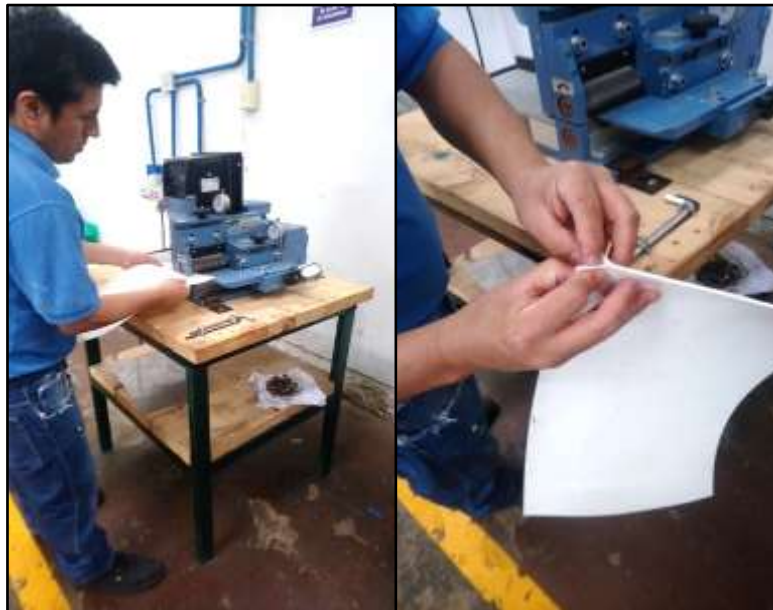
Figura 37: Traslapado de la faja transportadora
