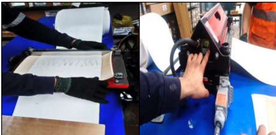
Figura 39: Vulcanizado de la faja transportadora
