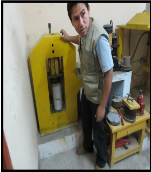
COLOCADO DE LA PROBETA PARA EL ENSAYO A COMPRESIÓN
