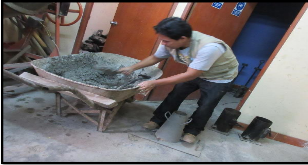
VACIADO DE MEZCLA PARA EL DISEÑO DE PROBETAS
