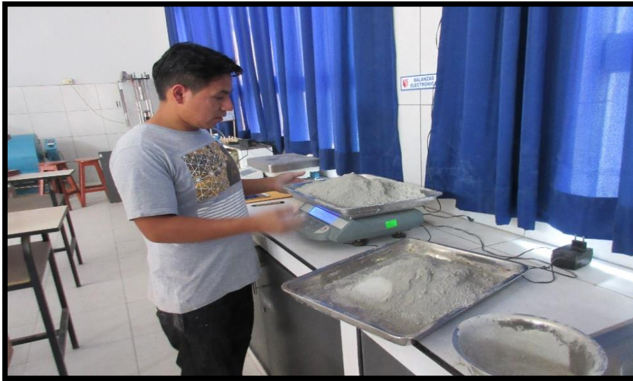
SE HACE EL PESADO DE MATERIALES PARA EL DISEÑO DE PROBETAS EN EL LABORATORIO DE LA UCV
