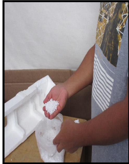
POLIESTIRENO EXPANDIDO RECICLADO DE PROTECTORES DE ELECTRODOMÉSTICOS
