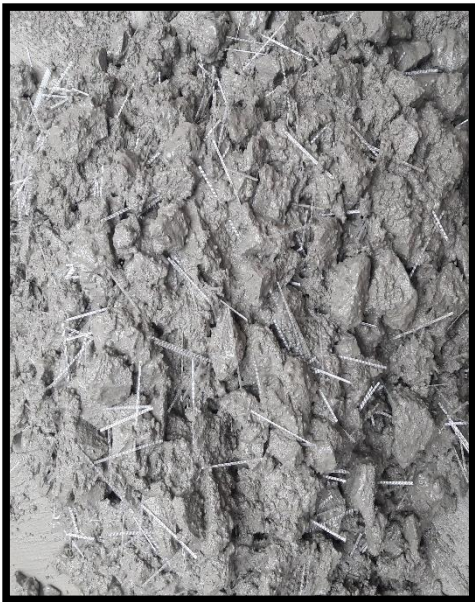
MEZCLA CON ADICIÓN DE FIBRAS DE POLIPROPILENO
